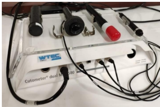
Figura 12 - Equipamento Cutometer® dual MPA 580 do fabricante Courage & Khazaka, com as sondas Corneometer®, Tewameter® e Mexameter® utilizadas neste trabalho.
