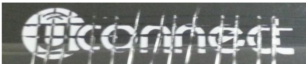
Figura 31 - Resultado obtido no teste de linhas cruzadas para a tinta do tipo ACP
