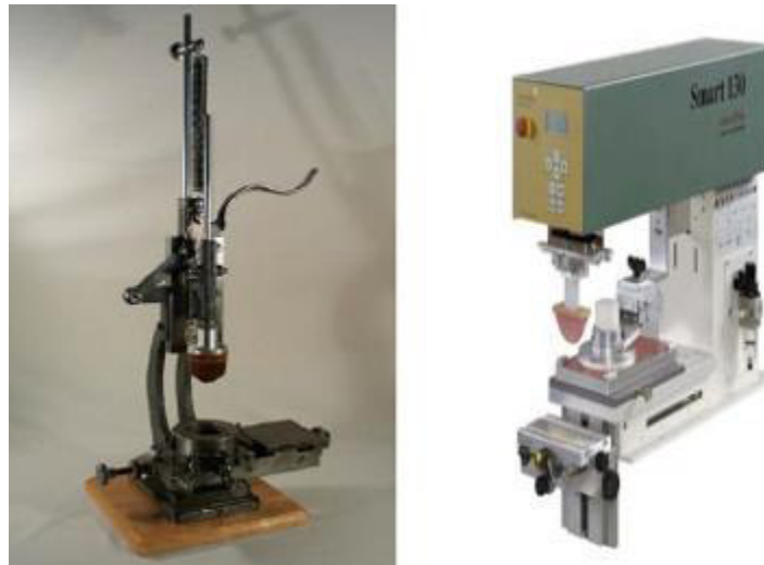
Figura 8 - Na imagem à esquerda pode-se observar uma das primeiras máquinas de tampografia, à direita uma máquina atual (microPrint, 2016)
