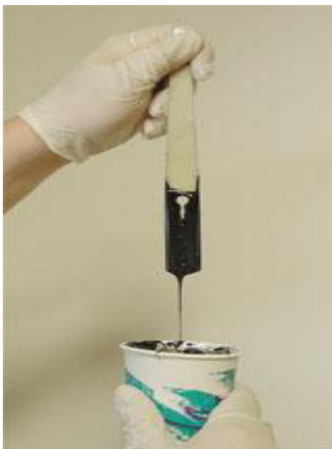
Figura 37 – Medição da viscosidade de tinta
