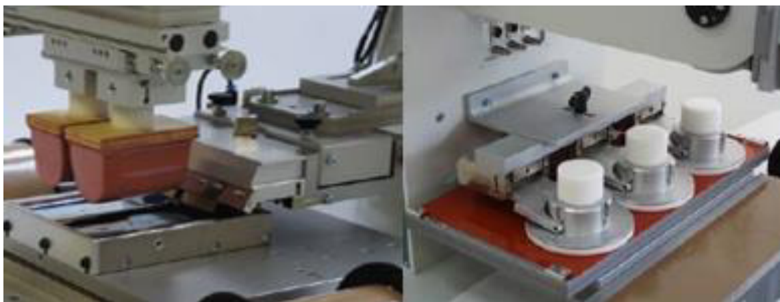
Figura 12 - Na imagem da esquerda está representado um sistema de tinta aberta e na imagem da direita um sistema de tinta fechada (microPrint, 2016)
