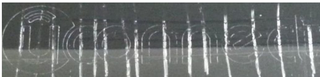
Figura 30 – Resultado obtido no teste de linhas cruzadas para a tinta do tipo B
