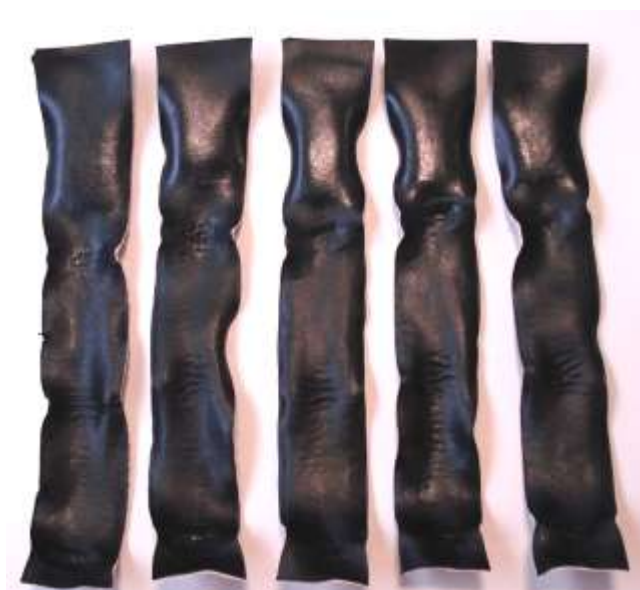
Figura 32. Amostras 1.A, 2.B, 3.C, 4.B e 5.A após o ensaio de imersão em acetona
