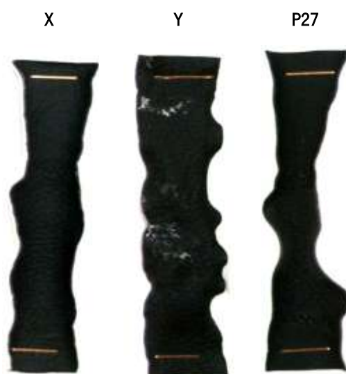
Figura 43. Provetes X, Y e P27 após imersão em acetona
