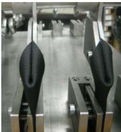
Figura 21. Amostras em posição de teste no Bally Flex Tester.
