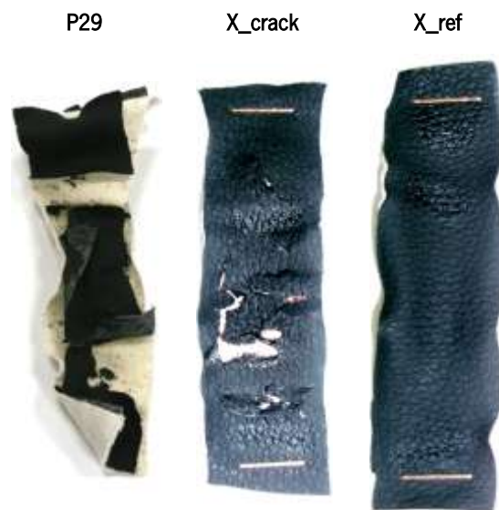
Figura 47. Provetes X, Y, P27, P29, X_crack e X_ref após imersão em acetona.
