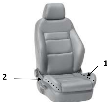
Figura 9. Representação esquemática das zonas de falha típicas (adaptado de [10]).
