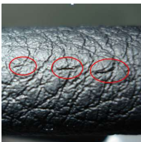
Figura 42. Fissuras visíveis no provete com o gravado C após o ensaio de resistência ao frio a -40°C.
