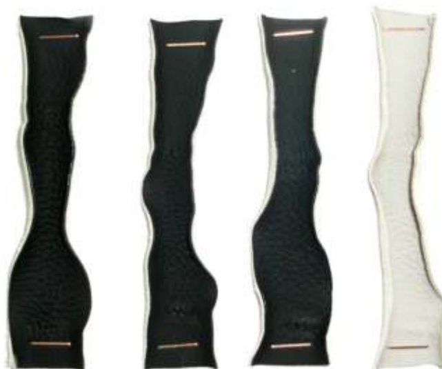
Figura 36. Provetes referentes às amostras P27, P27_didp, P39_P e P39_B, respectivamente, após imersão em acetona.
