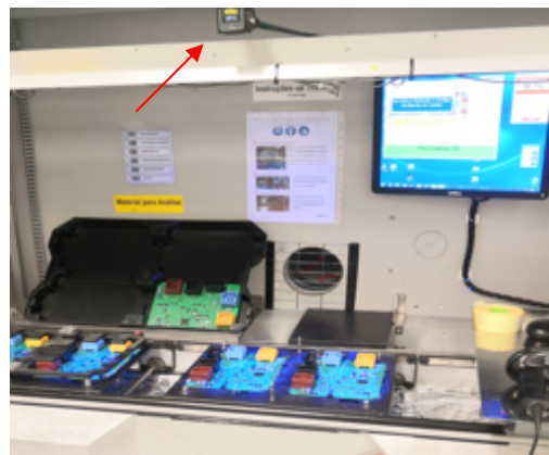
Figura 39 - Novo sensor em altura no Coating Line.
