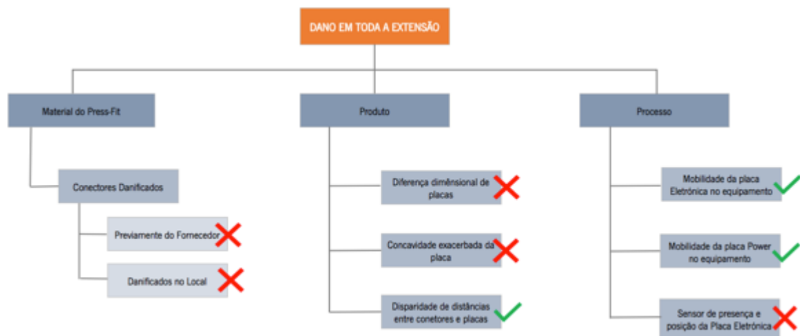
Figura 61 - Árvore de falhas para o defeito do tipo A.
