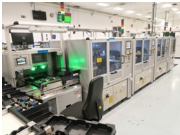
Figura 26 - Posto Fuse Intertion
