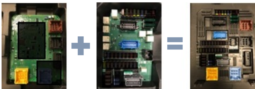
Figura 17 - Placa eletrónica, placa power e, módulo final, respetivamente da esquerda para a direita.
