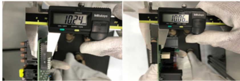
Figura 62 - Disparidade de distâncias entre conector e placa.
