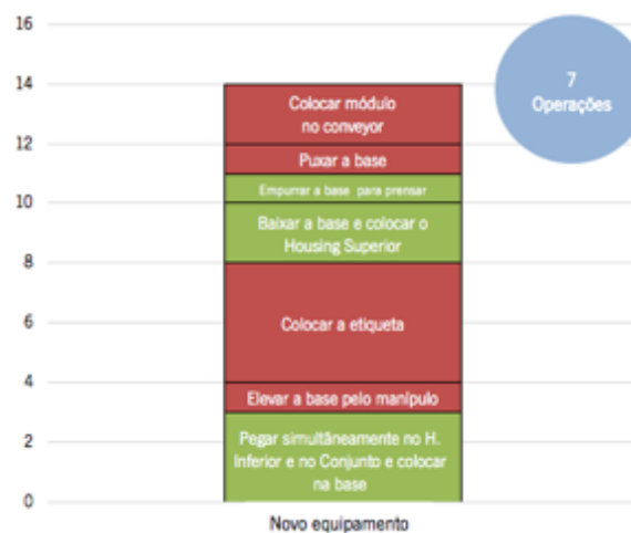
Figura 98 - Yamazumi de operações e tempos (segundos) previstos a partir do novo equipamento.
