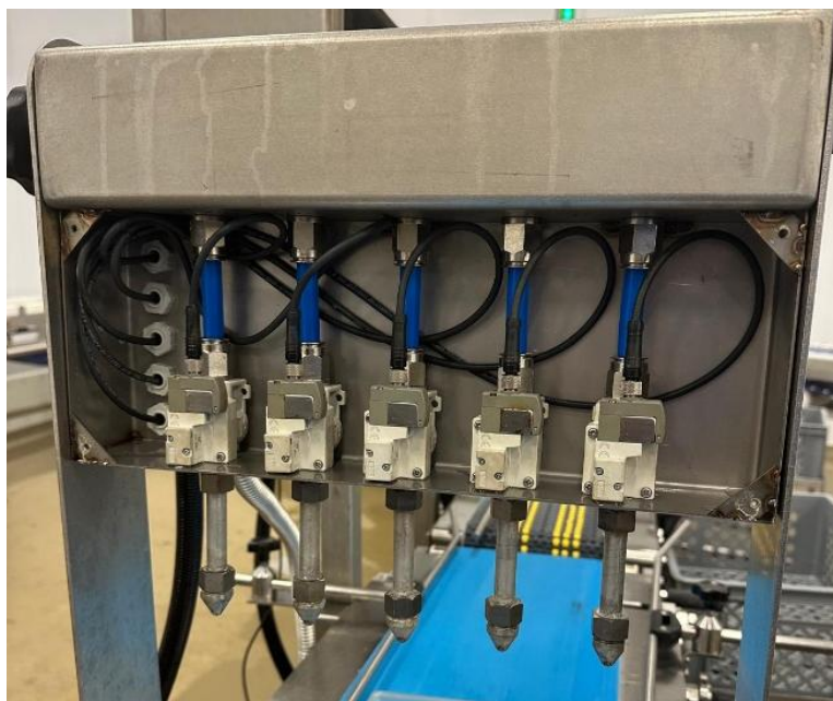
Figura 3.8 - Conjunto de válvulas pneumáticas de impacto
