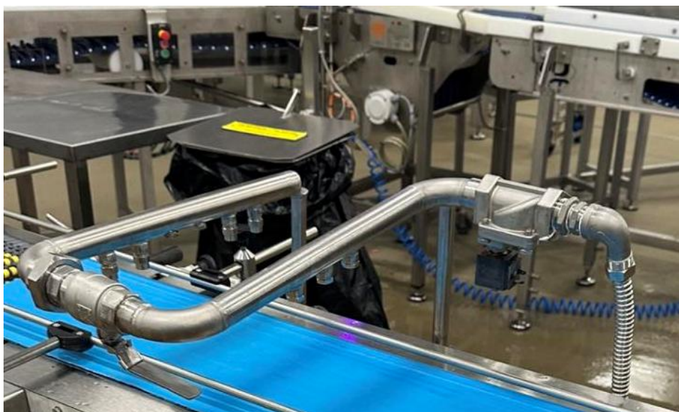
Figura 3.6 – Tubo com bicos de ar comprimido abertos como uma das soluções
