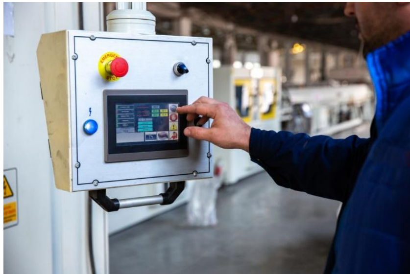
Figura 3.3 - Interfaces homem-máquina (HMI) [19]
