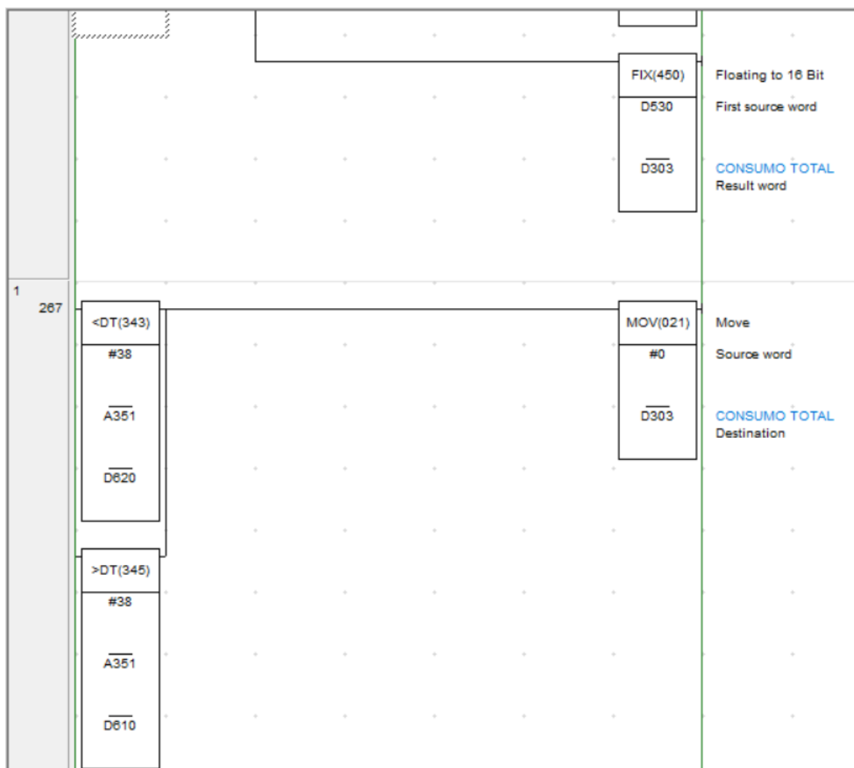
Figura 4.78 - Código da programação para calcular o consumo total de ar comprimido
