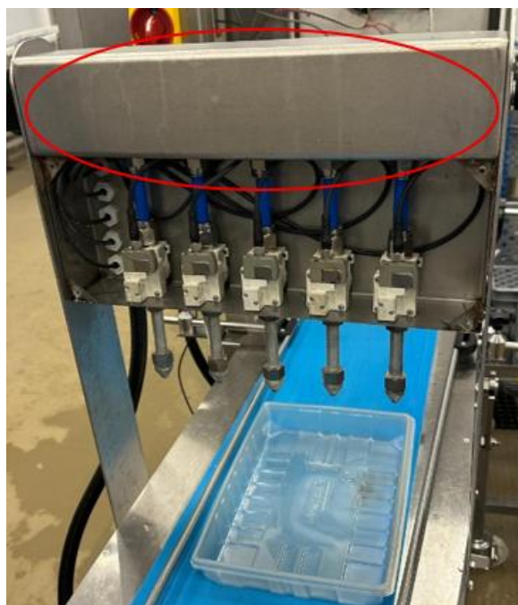
Figura 5.2 – Configuração final do equipamento com o reservatório de ar implementado
