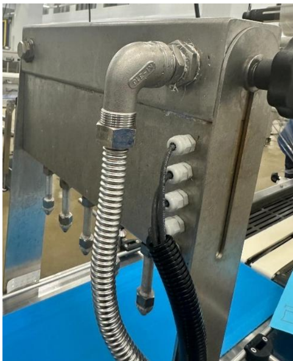
Figura 5.5 -Tubo de alimentação de ar comprimido para o reservatório de ar e cabos de alimentação elétrica
