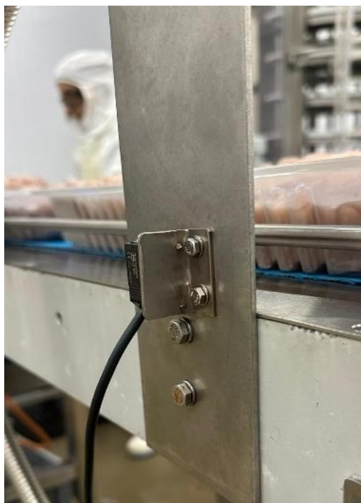
Figura 5.8 -Vista lateral da posição do sensor e suporte para o mesmo
