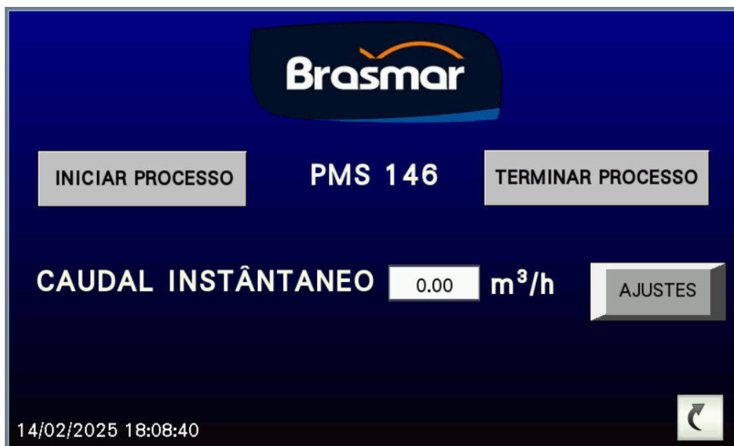
Figura 4.16 – Informação dos valores do caudal instantâneo de ar comprimido em m3/h
