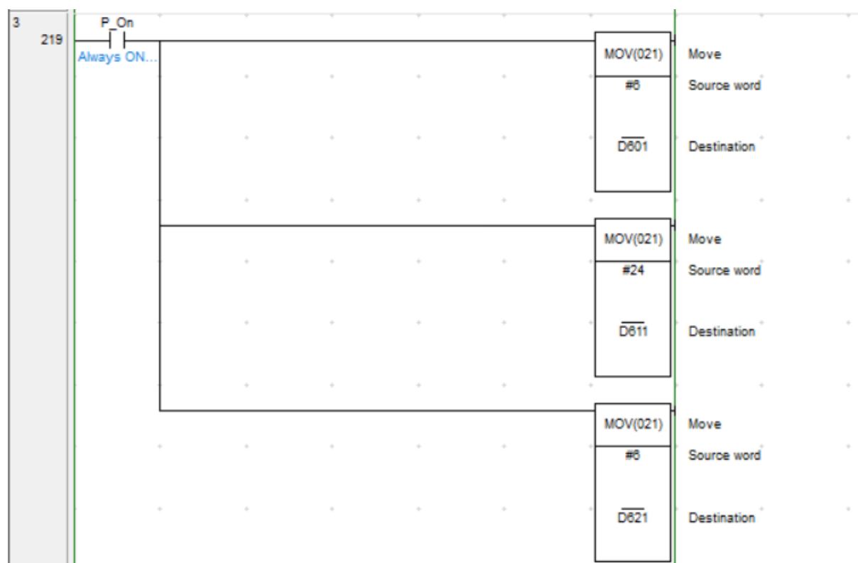
Figura 4.68 - Código da programação da contagem das cuvetes
