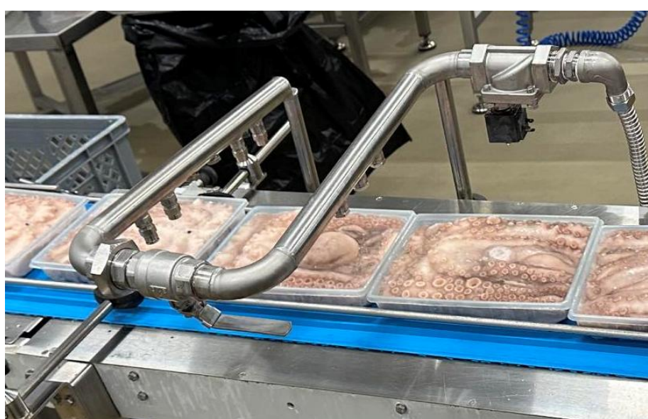
Figura 3.7 - Tubo com bicos de ar comprimido abertos em uso na linha
