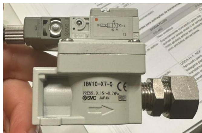
Figura 4.43 - Válvula de impacto SMC IBV10-X7-Q
