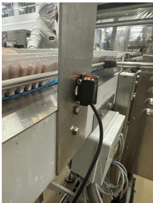
Figura 4.9 - Sensor fotoelétrico integrado na linha
