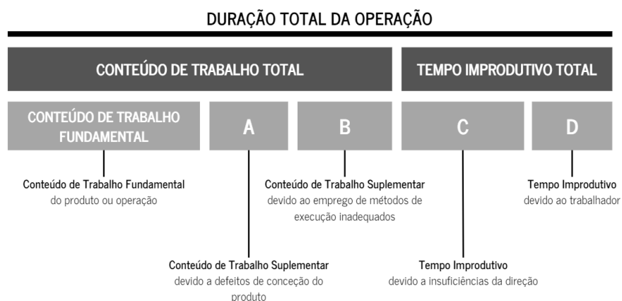
Figura 2 - Decomposição da duração total da operação de fabricação de um produto.
