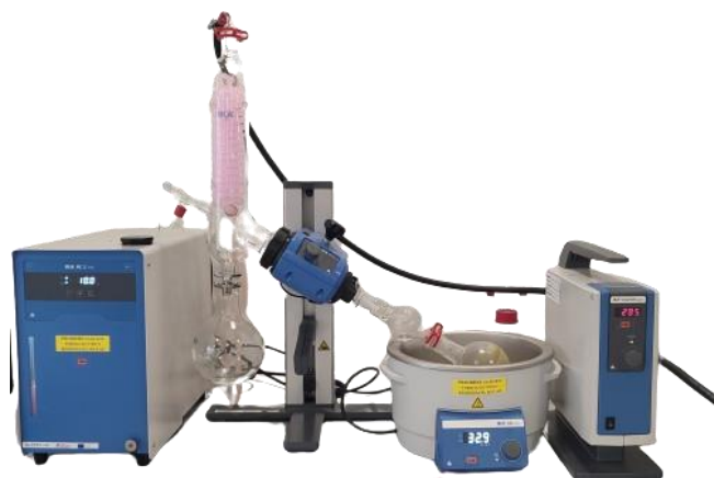
Figura 15. Evaporador Rotativo IKA RV 3 V .
