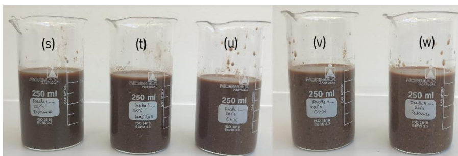
Figura A7. Extrações efetuadas com dreche 20% sólidos antes da filtração: (s) Dreche 1 mm 20% s pectinase; (t) Dreche 1 mm 20% s 100% H 2 O; (u) Dreche 1 mm 20% s celulase + xilanase; (v) Dreche 4 mm 20% s celulase + xilanase; (w) Dreche 4 mm 20% s pectinase.
