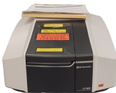
Figura 14. Espectrofotómetro UV-vis SHIMADZU UV-2600i.
