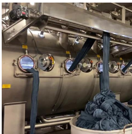
Figura 2. Representação do equipamento utilizado para funcionalização de materiais têxteis por esgotamento (Esquire Group, 2025).
