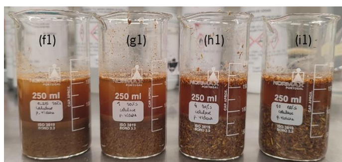
Figura A10. Extrações efetuadas com podas de videira 10% sólidos antes da filtração: (f1) Podas de videira 0,25 mm 10% s celulase; (g1) Podas de videira 1 mm 10% s celulase; (h1) Podas de videira 4 mm 10% s celulase; (i1) Podas de videira 10 mm 10% s celulase.
