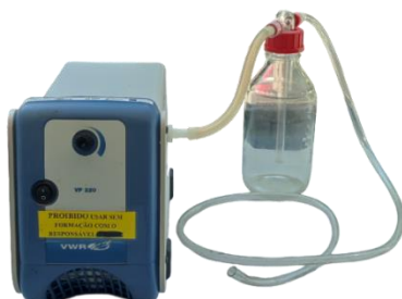
Figura 13. Bomba de vácuo VWR VP 220 .
