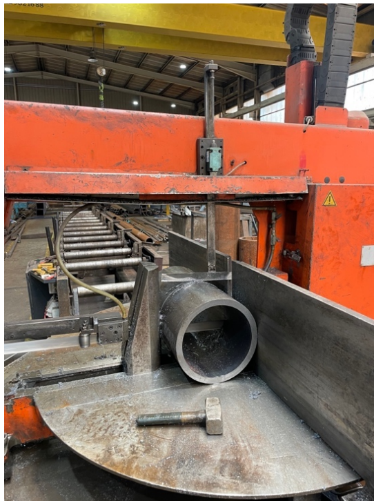
Figura 18 - Serrote FAT a cortar um perfil CHS.
