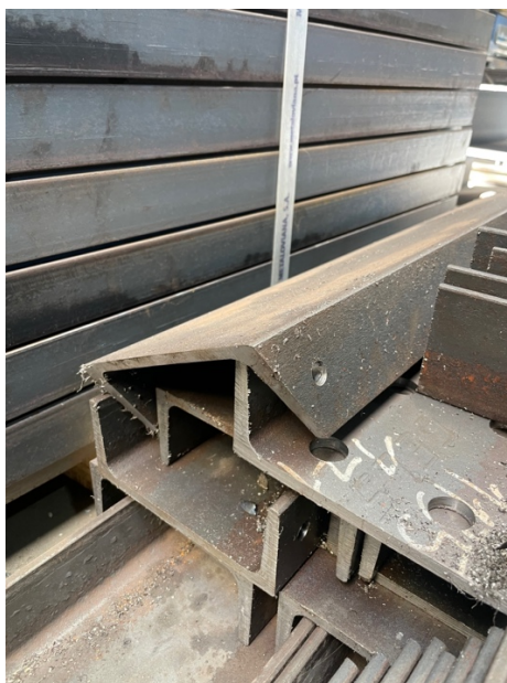
Figura 23 - Peça final em que o ângulo não é compatível com o corte.
