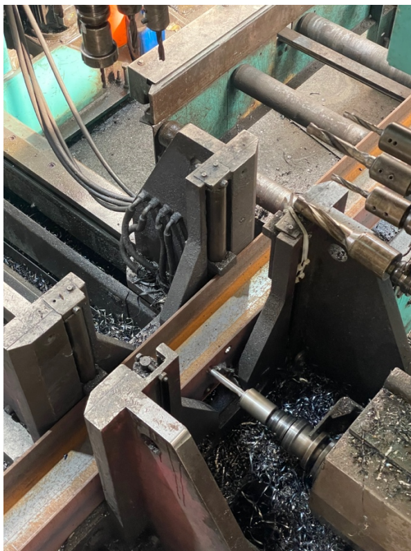
Figura 27 - Fixação dos perfis durante a furação.
