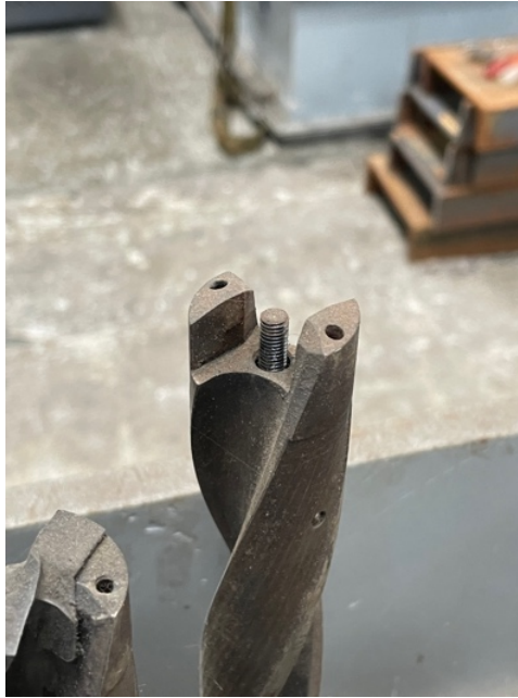
Figura 6 – Corpo de uma broca helicoidal sem pastilha.
