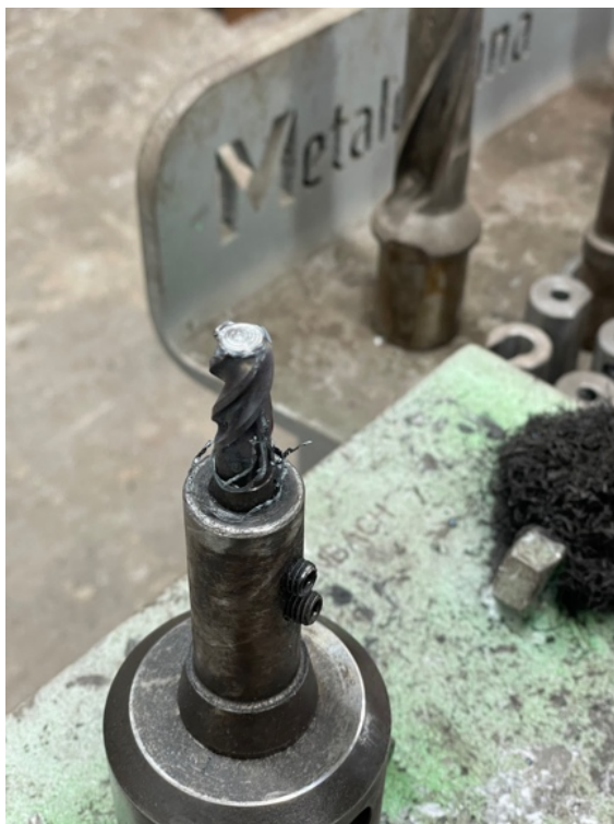
Figura 10 - Fresa após vida útil.
