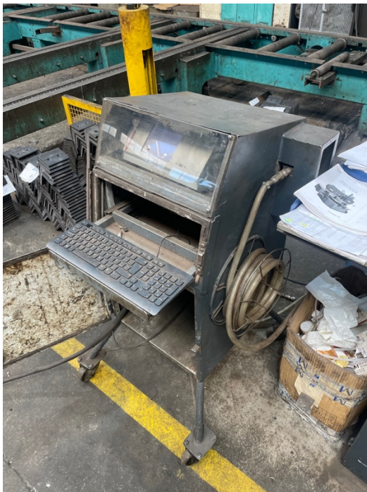
Figura 31 - Máquina para gravar a referência das peças (MCP1).
