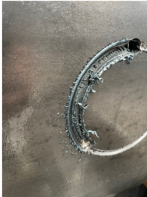
Figura 12 - Furo começado por uma fresa que perdeu a capacidade de arrancar aparta.
