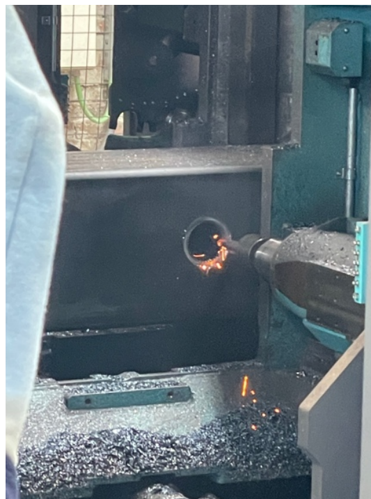
Figura 9 - Fresa a trabalhar com elevado desgaste.
