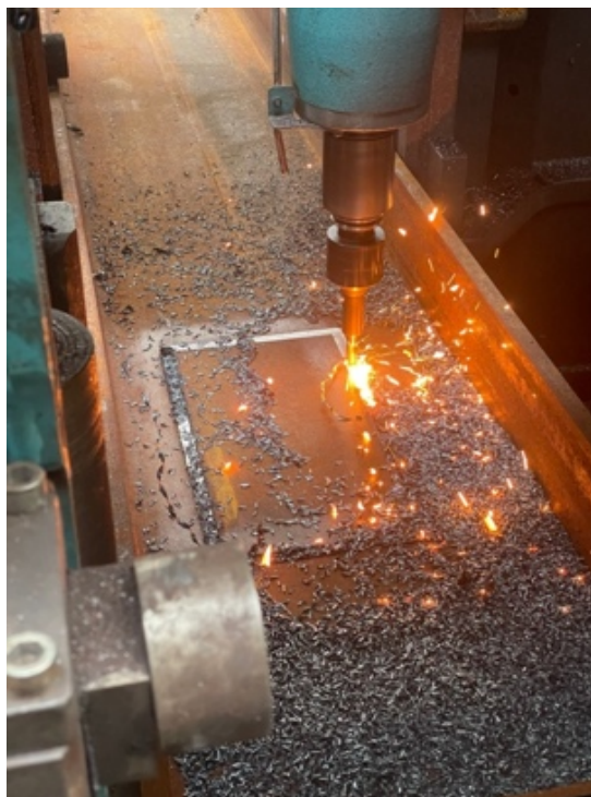
Figura 11 - Excesso de aparas de aço durante a fresagem.
