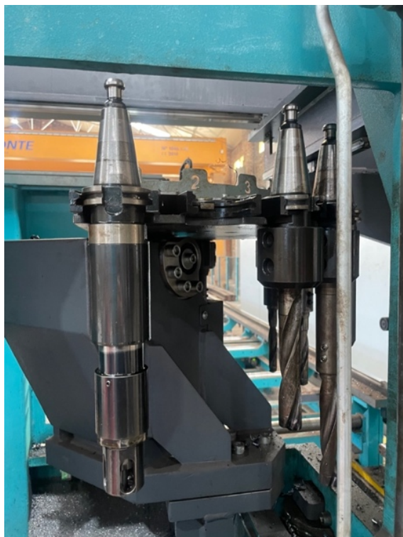
Figura 28 - Mandril para colocar brocas e fresas.
