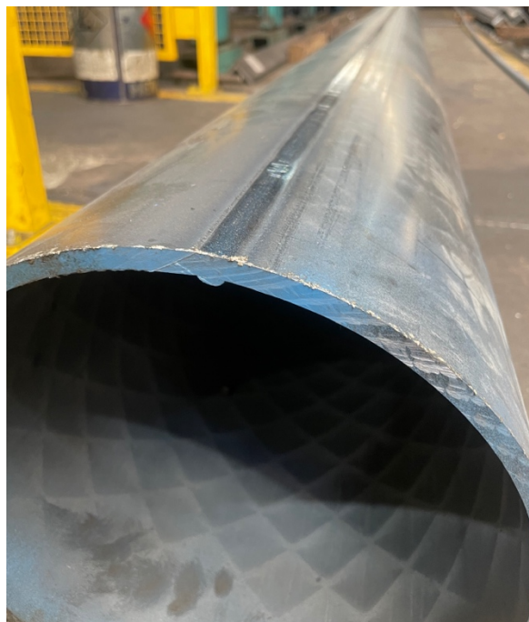
Figura 4 – Tubo CHS conformado a frio por perfilagem com cordão de soldadura.
