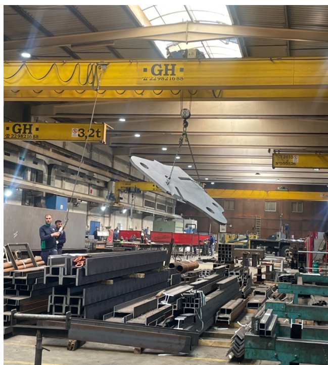
Figura 22 - Ponte utilizada para movimentar as peças dentro do armazém.
