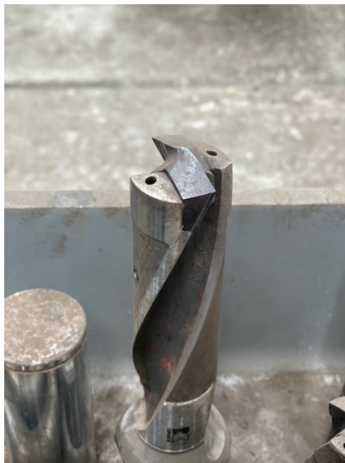
Figura 7 – Broca helicoidal com pastilha.
