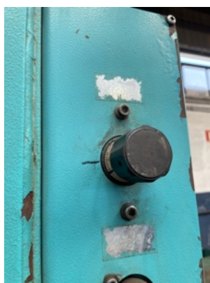
Figura 15 – Manipulo para controlar a velocidade de descida da serra.
