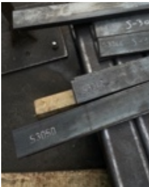
Figura 32 - Gravação da referência da peça utilizando a máquina (MCP1).
