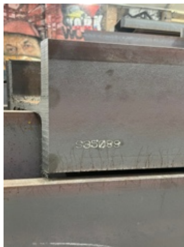
Figura 33 - Referência da peça gravada por fresagem no polo 3 (MCP3).
