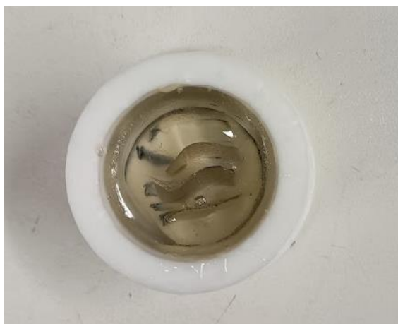
Figura 36: Amostras envolvidas em resina dentro de um molde indicado para o efeito
