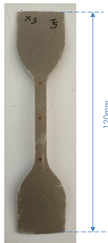
Figura 19: Ilustração de um provete obtido para os ensaios de tração
