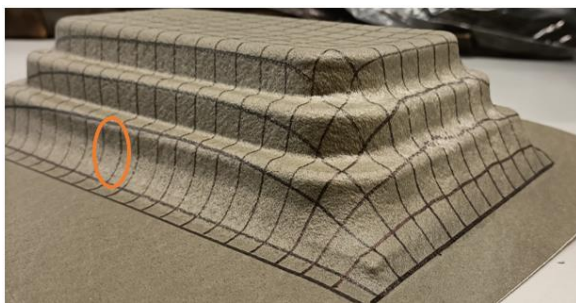
Figura 35: Seleção da zona a analisar da peça termoformada
