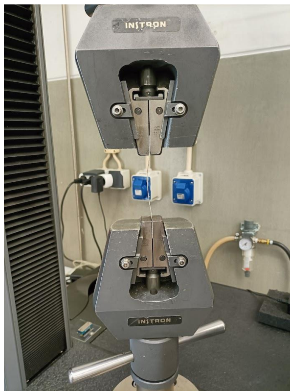
Figura 21: Colocação da amostra nas amarras do equipamento
