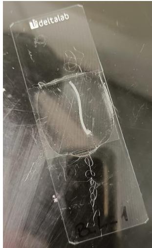
Figura 33: Amostra entre duas lamelas, embebida em bálsamo do Canadá
