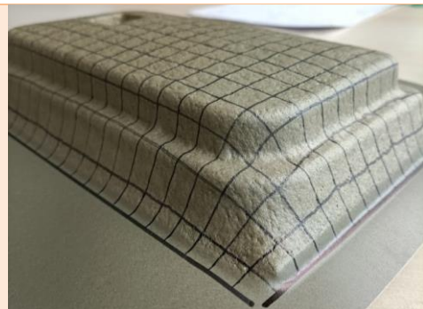
(F) Peça termoformada no molde com 2 patamares e 1 furo – vista lateral (15%carga(F38)+F10)
