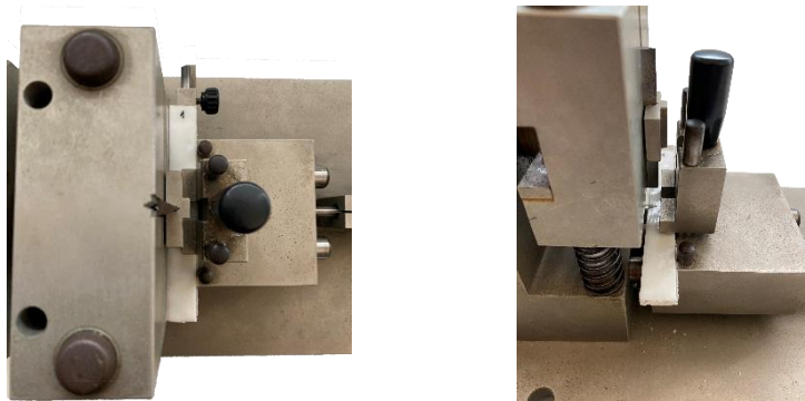
Figur 25– Entalhe em “V” nos provetes
