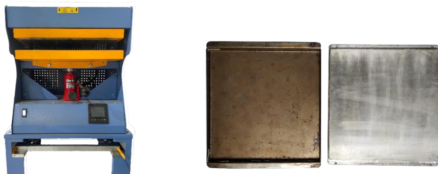
Figura 58 – Prensa CR Clarke & Co R30 e molde – 350x350x5 mm
