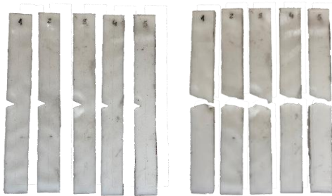
Figura 30 – Antes e depois dos provetes das placas 4 e 1, respetivamente
