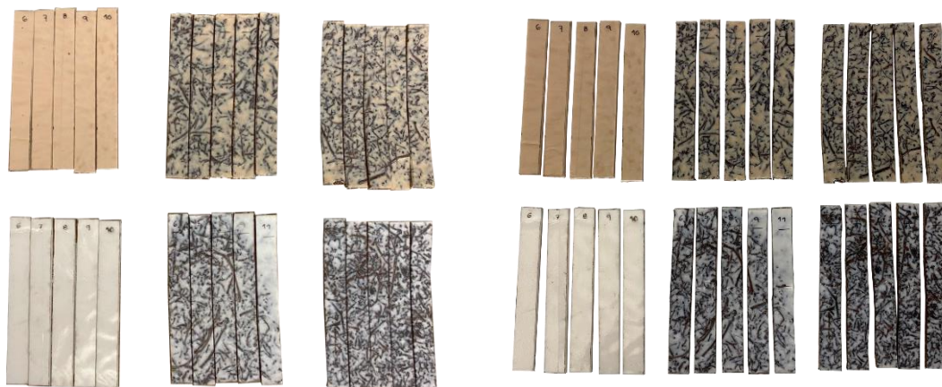
Figura 39 – Antes e depois dos provetes em relação ao ensaio de flexão
