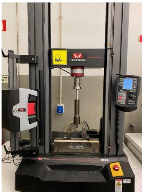
Figura 26 – Equipamento de ensaios mecânicos INSTRON 4505
