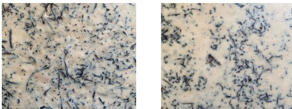
Figura 23 – Impacto do processo de secagem nas placas de compósito
