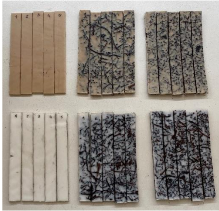
Figura 29 – Antes e depois dos provetes em relação ao ensaio de impacto
