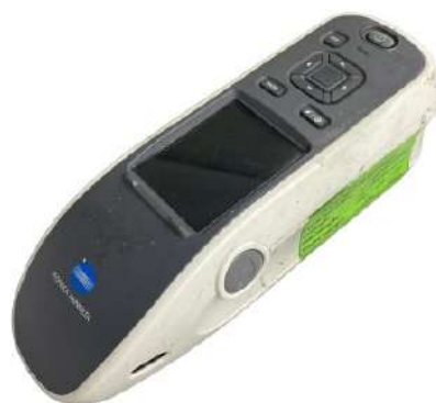
Figura 21. Medidor de cor e brilho
