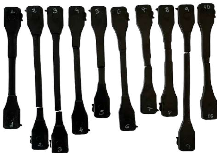
Figura 53. Provetes PC 1º ciclo após ensaio de tração
