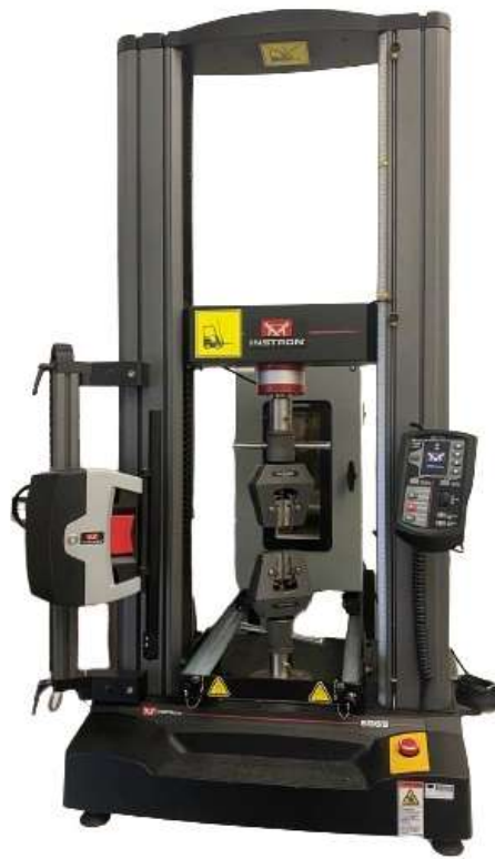
Figura 23. Equipamento utilizado para tracionar os provetes
