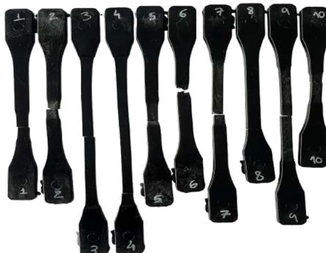
Figura 59. Provete PC RE 2º ciclo após ensaio de tração
