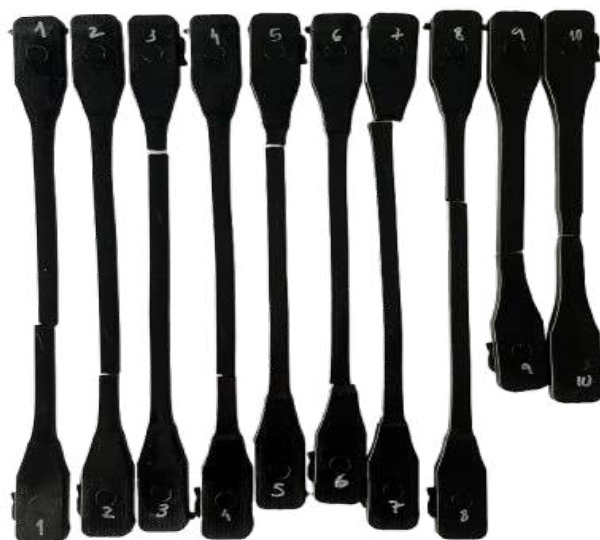
Figura 61. Provete PC RE 4º ciclo após ensaio de tração
