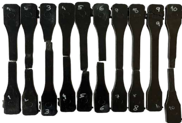
Figura 57. Provete PC 5º ciclo após ensaio de tração
