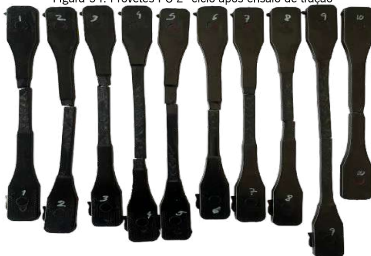
Figura 55. Provetes PC 3º ciclo após ensaio de tração
