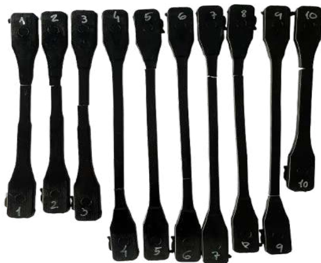
Figura 62. Provete PC RE 5º ciclo após ensaio de tração
