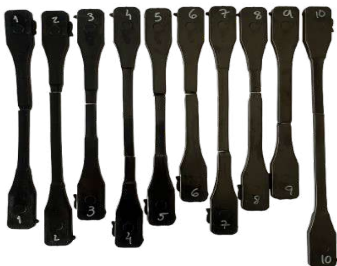
Figura 56. Provete PC 4º ciclo após ensaio de tração
