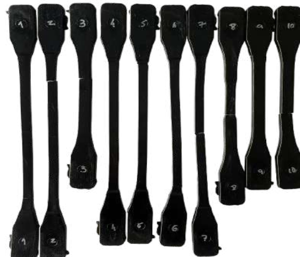
Figura 60. Provete PC RE 3º ciclo após ensaio de tração
