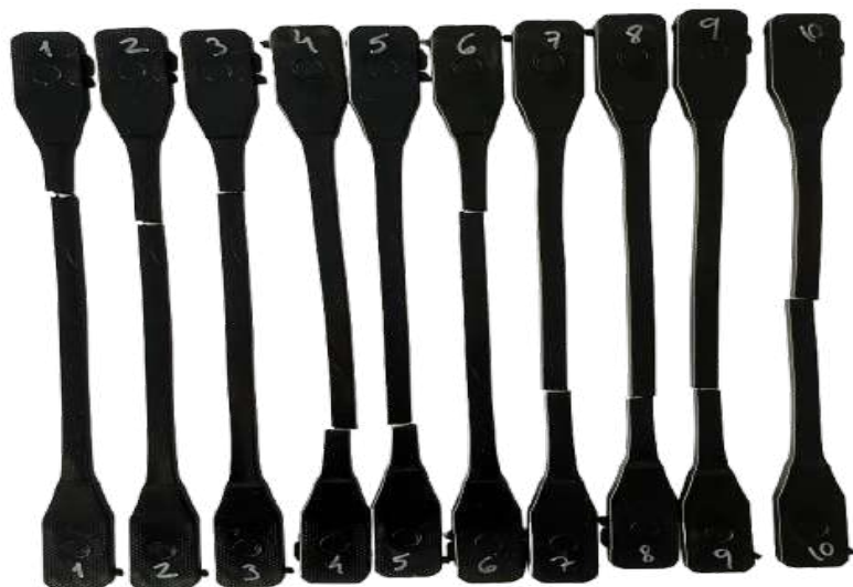
Figura 58. Provete PC RE 1º ciclo após ensaio de tração
