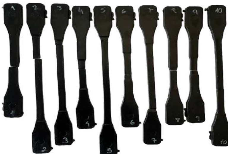
Figura 54. Provetes PC 2º ciclo após ensaio de tração
