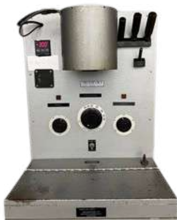
Figura 20. Aparelho utilizado para a realização do MFI
