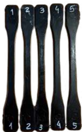
Figura 16. Provetes obtidos nos diferentes ciclos de reproprocessamento
