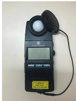
Figura 8. Iluminânciômetro Konica Minolta T-10.
