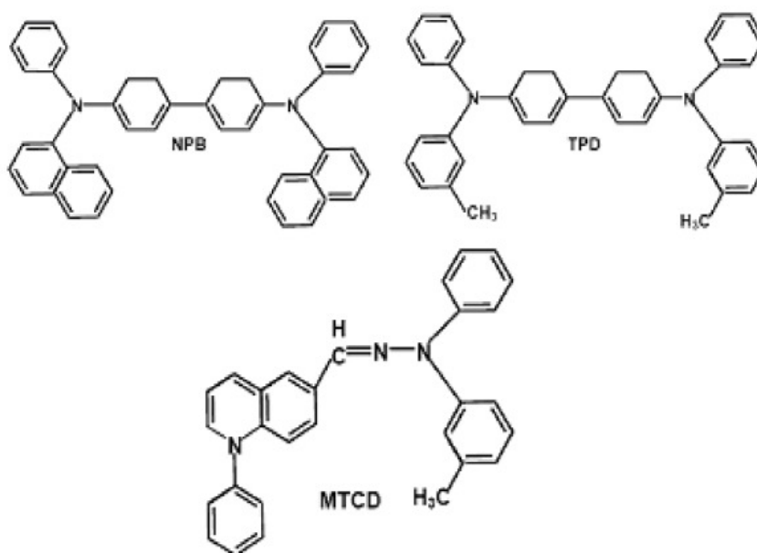
Figura 3.8 – Estrutura molecular de materiais utilizados para a HTL [21]
