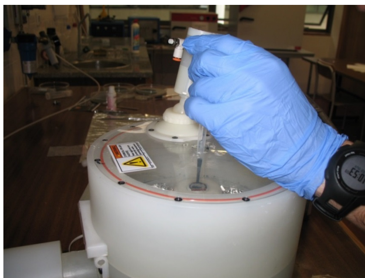
Figura 4.19 – Deposição do PEDOT/PSS.
