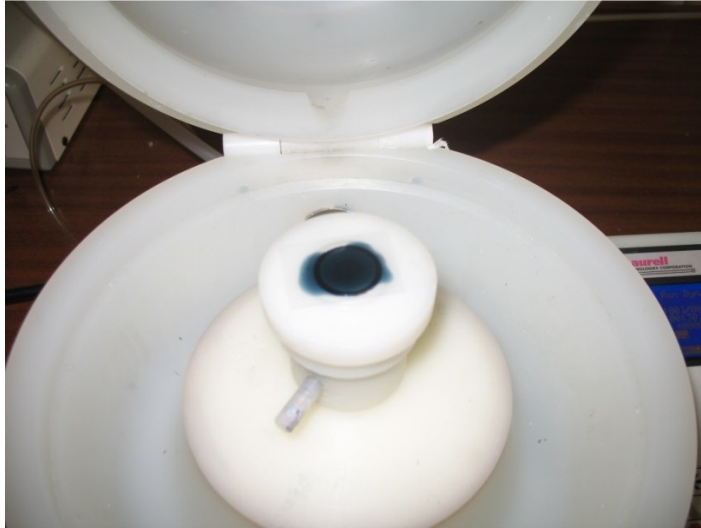
Figura 4.21 – PEDOT/PSS depositado por cima do ITO em lamela de vidro.
