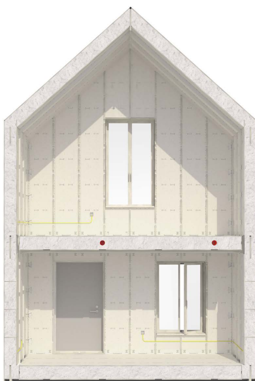
Fig. 1.4.3 - Interior de uma estrutura WikiHouse, em corte.
