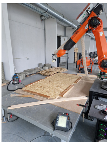
Fig. 3.2.2 - Foto do robô KUKA realizando as fresagens. Foto de RC.
