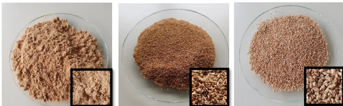
Figura 14 - Ilustração do aspeto das diferentes granulometrias de cortiça utilizadas.
