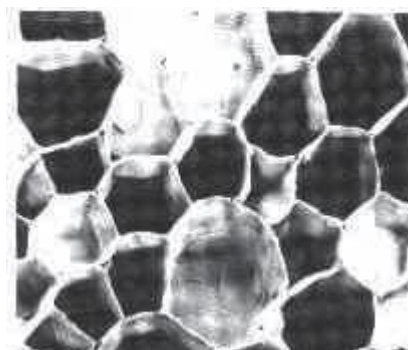
Figura 8 - Células de cortiça. Retirado de [48].
