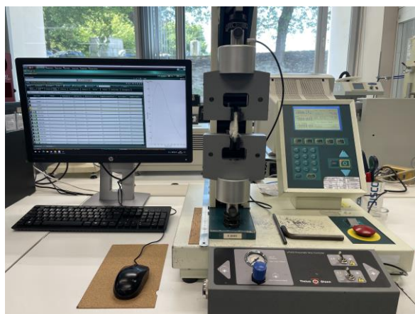
Figura 15. Equipamento utilizado para avaliar a resistência mecânica das estruturas obtidas.
