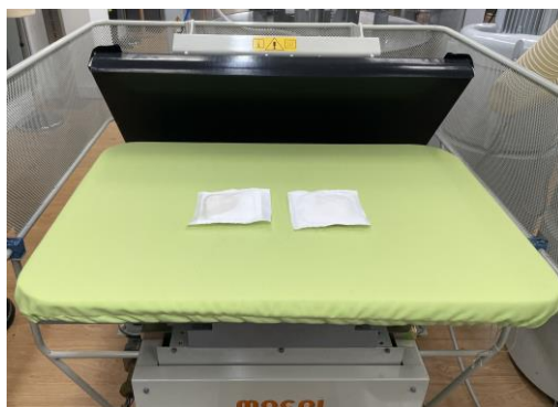
Figura 18. Prensa térmica utilizada na etapa de laminação.
