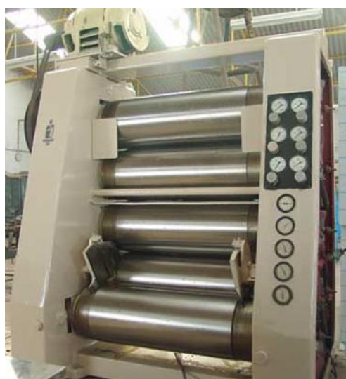
Figura 7 - Equipamento refinador de cinco cilindros (ExportersIndia.com, 2021).
