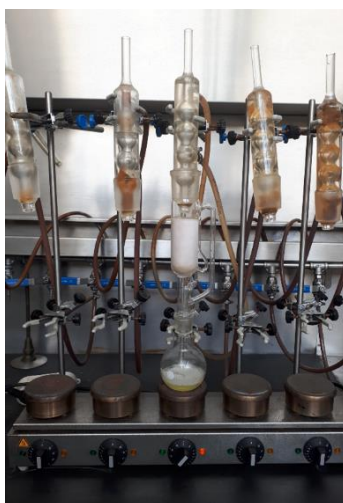
Figura 18 - Equipamento de Soxhlet montado, durante a extração.
