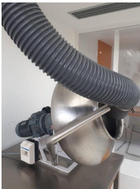
Figura 13 - Equipamento utilizado para drageados.
