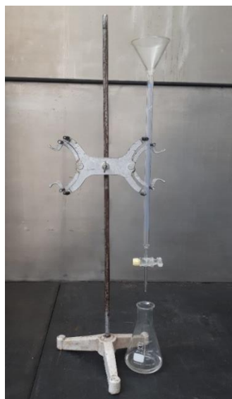
Figura 26 – Material necessário para realizar uma titulação.
