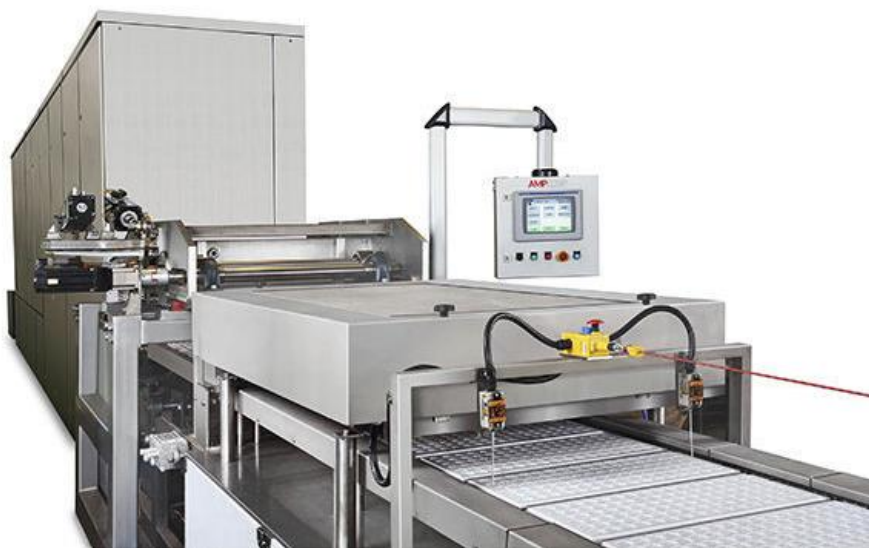
Figura 11 - Equipamento de moldação para tabletes de chocolate (Directindustry, 2021).
