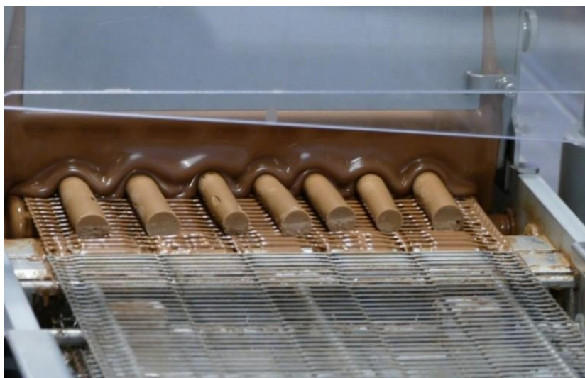
Figura 12 - Equipamento de revestimento em operação (Potrowl, 2019).
