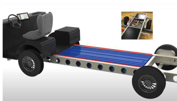
Figura 2 - bateria do veículo (City Freighter, 2019)
