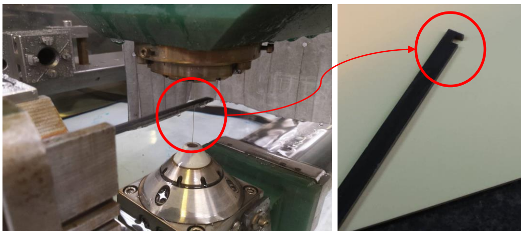
Figura 40 - EDM por Fio, Corte de um Extrator Lâmina. 5
