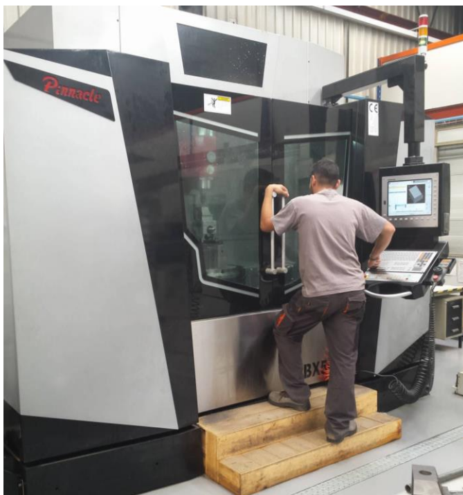
Figura 43 - Maquinação CNC (5 eixos) de um eletrodo em cobre. 5
