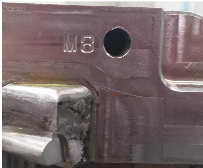
Figura 47 - Marcação, identificação do furo, M8. 5
