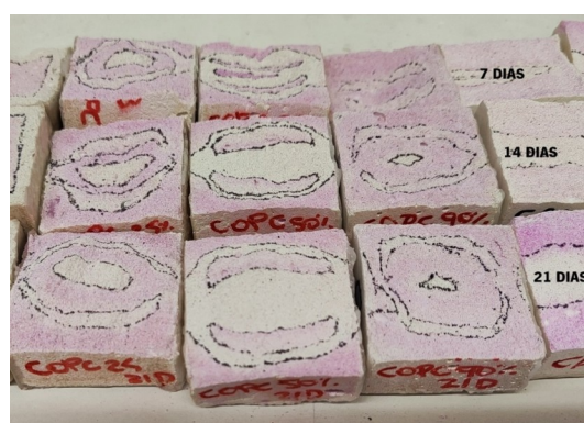
Figura 62 – Resultado da carbonatação dos provetes de conchas calcinadas (25, 50 e 90%, da esquerda para direita): 7; 14 e 21 dias (de cima para baixo)
