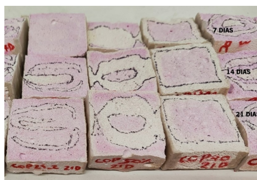
Figura 61 – Resultado da carbonatação dos provetes de conchas (25, 50 e 90%, da esquerda para direita): 7; 14 e 21 dias (de cima para baixo)
