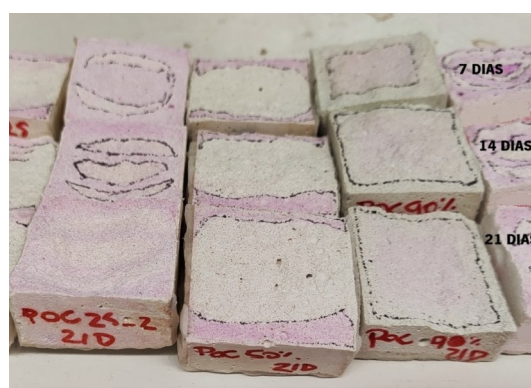
Figura 60 – Resultado da carbonatação dos provetes de poeiras (25, 50 e 90%, da esquerda para direita): 7; 14 e 21 dias (de cima para baixo)
