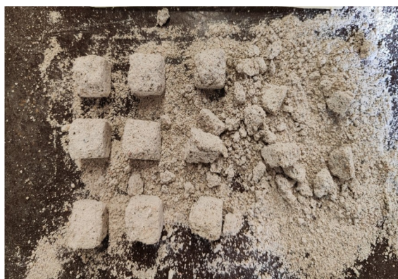
Figura 21 – Provetes de referência desintegrados após desmoldagem
