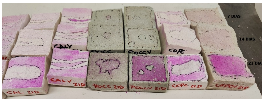
Figura 59 – Resultado da carbonatação dos provetes com apenas 1 ligante: 100% cal; 100% poeiras; 100% conchas em pó (da esquerda para direita): 7; 14 e 21 dias (de cima para baixo)
