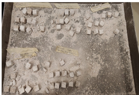
Figura 24 – Provetes desintegrados após 28 dias de cura
