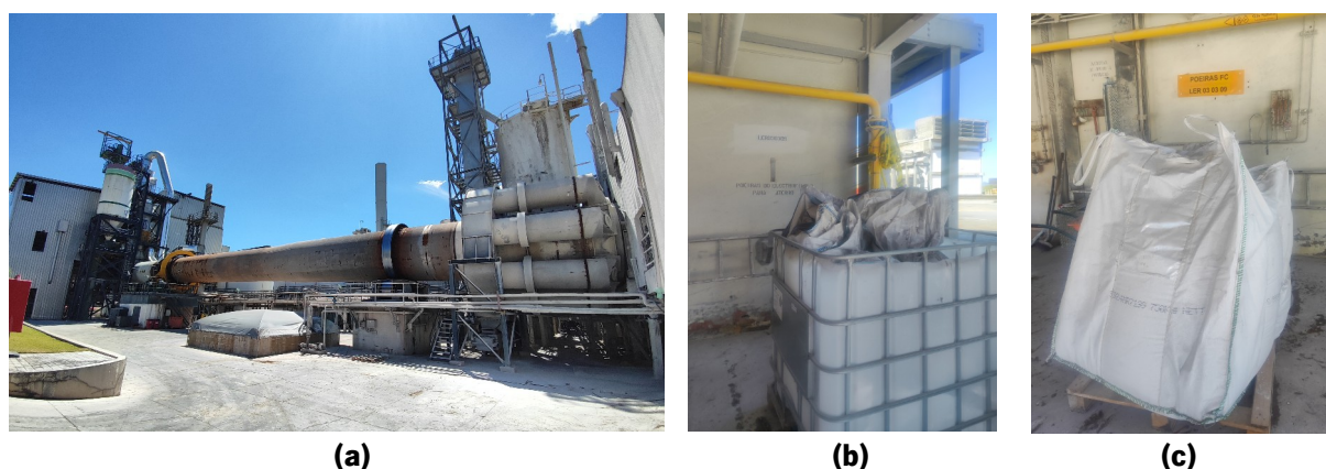
Figura 18 – Resumo do processo de recolha de poeira na fábrica: (a) Forno de cal; (b) Recolha das poeiras; (c) Big Bags prontos para levantamento
