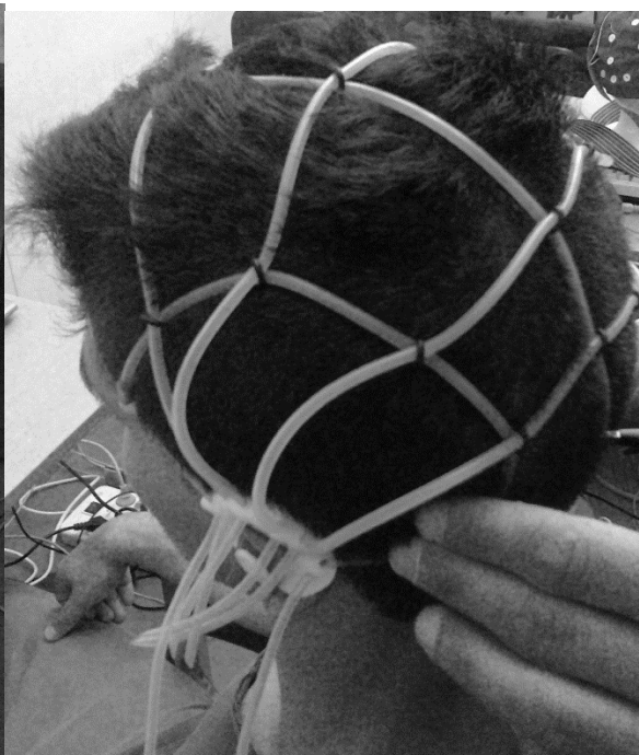
Figura 65 - Sistema de montagem da rede de elétrodos
