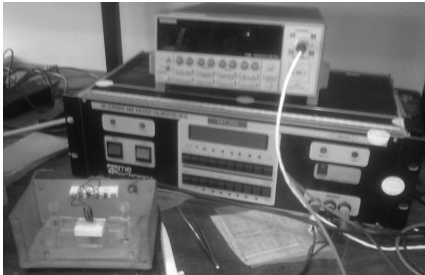
Figura 22 – Equipamento de medição de resistividade elétrica utilizado (geometria das 4 pontas em linha)
