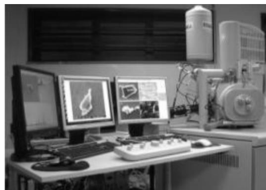
Figura 12 - Microscópio ótico FEI Nova 200 (FEG/SEM) (SEMAT) e Microscópio FEI Quanta 400FEG ESEM/EDAX Genesis X4M (CEMUP) utilizados
