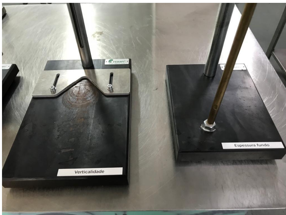
Figura 102-Identificação dos aparelhos de medição (verticalidade+espessura fundo)
