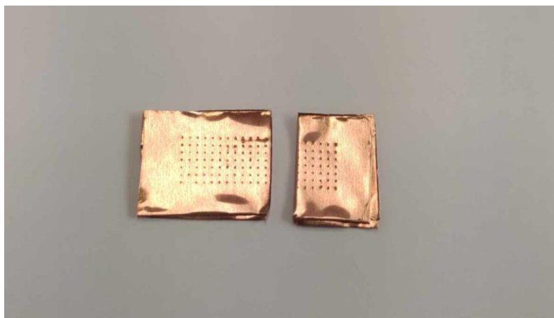
Figura 40 – Corte de uma amostra para posterior observação da secção soldada.
