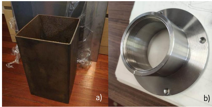
Figura 25 – a) carcaça do equipamento e b) flange maquinada.
