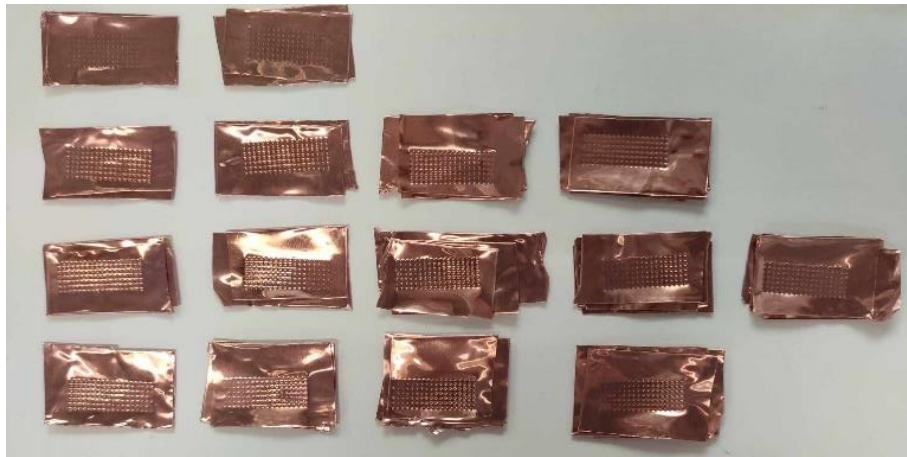
Figura 39 – Diferentes configurações de folhas de cobre, soldadas com várias forças de atuação.
