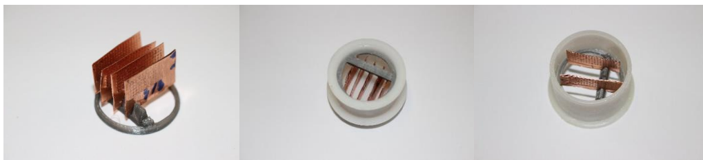
Figura 42 – Posicionamento de amostras no molde de resina.
