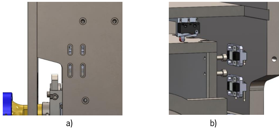
Figura 99 – a) Furos de ajuste vertical dos sensores magnéticos e b) suportes metálicos com ajuste horizontal dos sensores e parafusos de acionamento.
