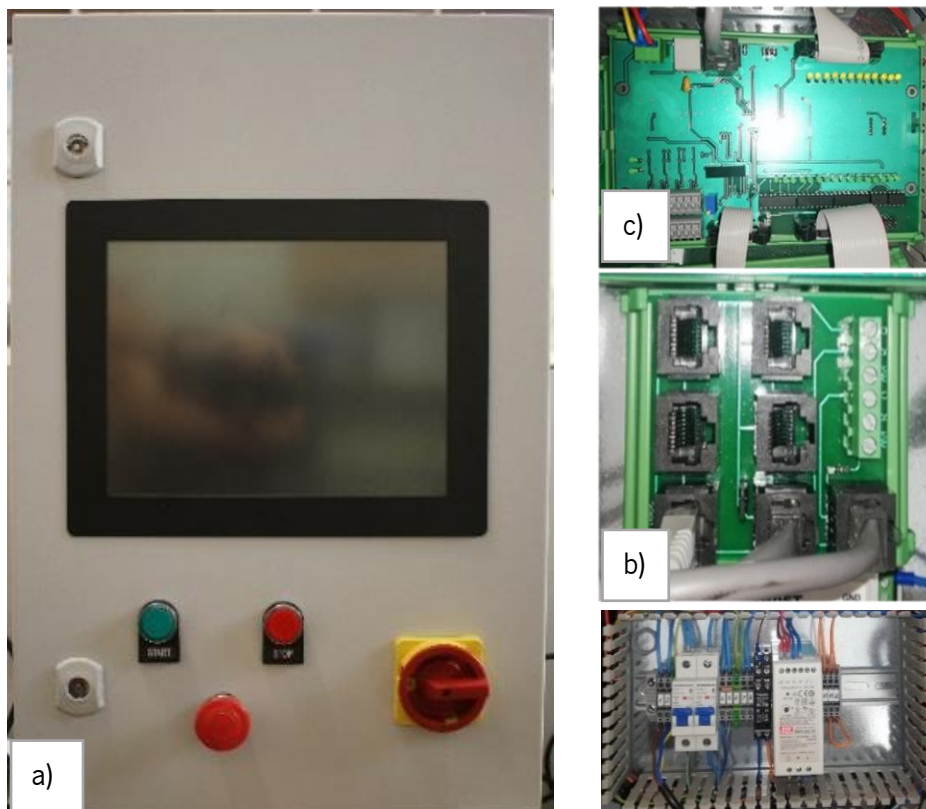
Figura 28 – a) Painel Frontal, b) Branchboard e c) Microcontrolador do equipamento.
