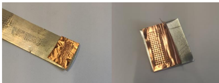
Figura 37 – Testes de soldadura executados para o par alumínio/cobre.
