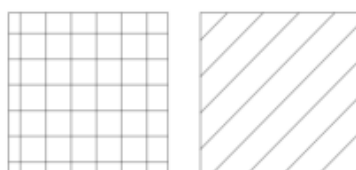
Figura 11 — Marcação de pavimentos e coberturas, respetivamente [28].
