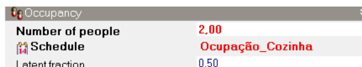
Figura 77 - Print screen da criação do perfil de ocupação da cozinha no modelo do edifício no DesignBuilder .
