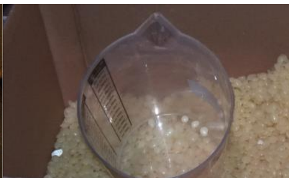
Figura 13 – Cola usada para unir as partes na montagem das pré-frames e frames
