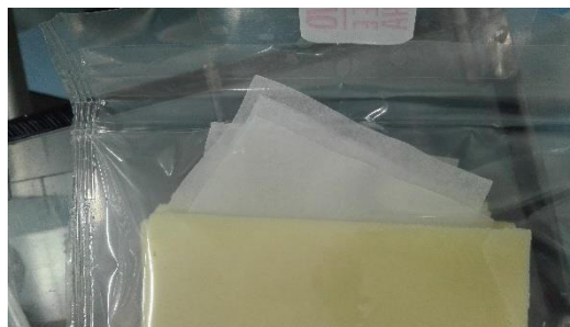
Figura 17 - Ilustração da situação (intercalar na soldadura) que provocou a fuga nos pacotes.
