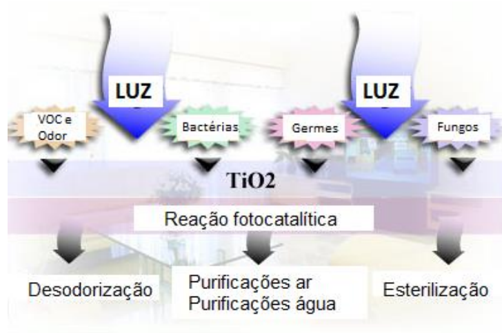
Figura 6 - Reação fotocatalítica do nano-TiO 2
