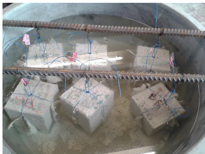
Figura 29 – Provetes dentro do recipiente emergidos numa solução de 10 % ácido sulfúrico
