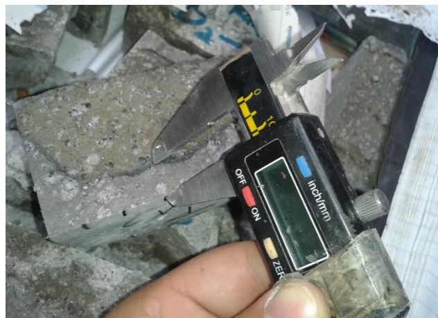
Figura 28 – Medição da profundidade da penetração de cloretos com paquímetro digital
