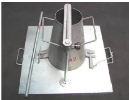
Figura 18 - Equipamentos necessários para a realização ensaio abaixamento
