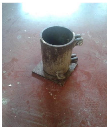
Figura 22 – Molde provetes cilíndricos (Ø100xH200) (mm 3 )
