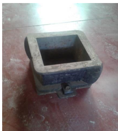
Figura 21 - Molde de provetes cúbicos (150x150x150) (mm 3 )
