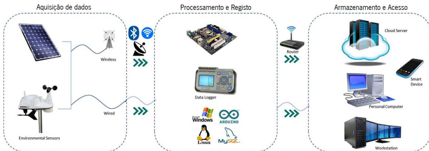
Figura 17 – Arquitetura de sistemas de monitorização
