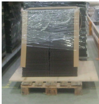
Figura 187 - Paletes descentradas nas baseboards
