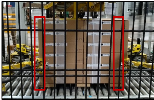
Figura 65 - Colocação de cantoneiras
