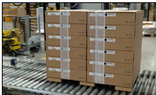
Figura 64 - Colocação de cintas
