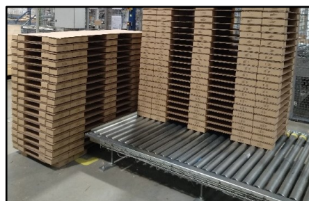
Figura 61 - Colocação de paletes de cartão nos conveyors das linhas
