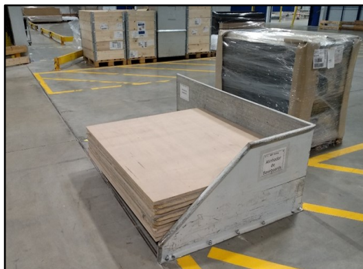
Figura 57 – Alinhador de baseboards localizadas no topo da linha Kallfass
