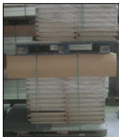
Figura 185 - Paletes com material descentrado nas baseboards
