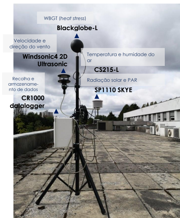
Figura 113. Estação meteorológica portátil desenhada em colaboração com a Escola de Arquitetura e de Engenharia da Universidade do Minho
