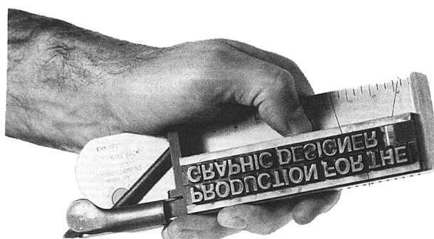
Figuras 22 e 23: ao lado, uma ilustração referente às primeiras impressoras tipográficas. Acima, um componedor , peça de composição das linhas de texto em tipografia usada intensamente até meados do século XX. (fontes: Ribeiro, 1987)
