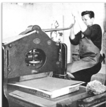
Figura 27: impressora de litografia, processo que dominou a impressão de cartazes e pôsteres no final do século XIX e início do século XX e que originou o processo de impressão mais usado na atualidade, o offset (fonte: Domiciano, 1998).
