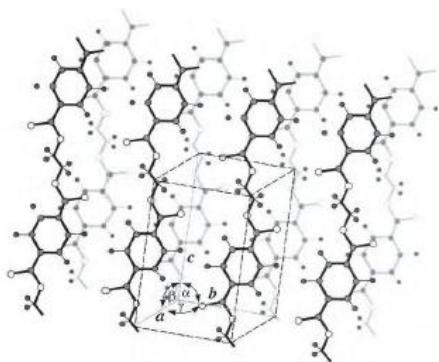
Figura 11- Estrutura cristalográfica do PET [30]
