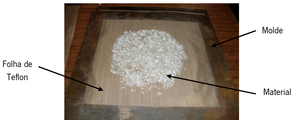
Figura 15- Molde utilizado para a produção de placas por Moldação por compressão
