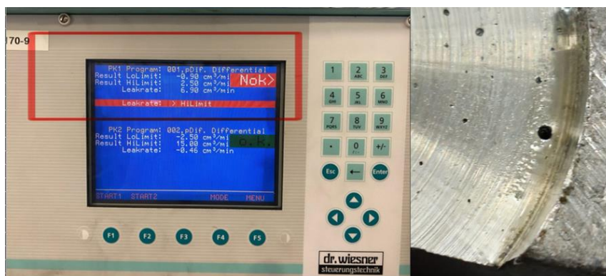
Figura 14 - Fugas de água identificadas
