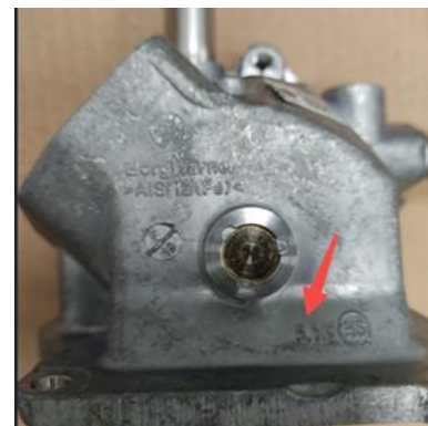
Figura 15 - Housing-Flap . Identificação do defeito
