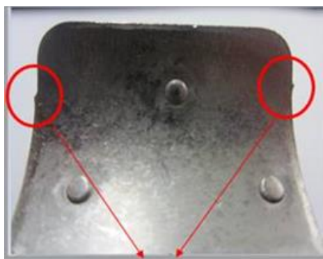
Figura 18 - identificação das não conformidade na bracket
