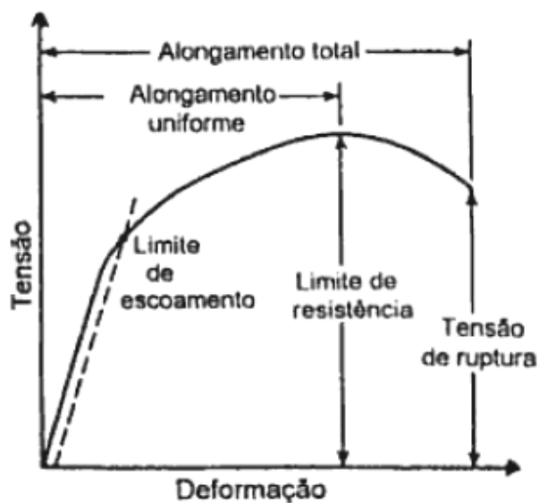
Figura 16 - Curva tensão-deformação [35].
