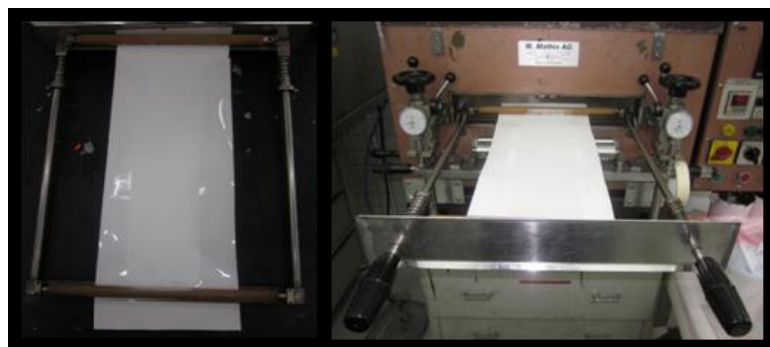
Figura 35 - Papel Ultracast Patent revestido com uma película fina de material e momento de retirada do sistema que contém o suporte apos conclusão do processo.
