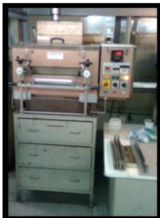
Figura 34 - Máquina (forno) de revestimento existente no laboratório da Endutex Revestimentos Têxteis SA.
