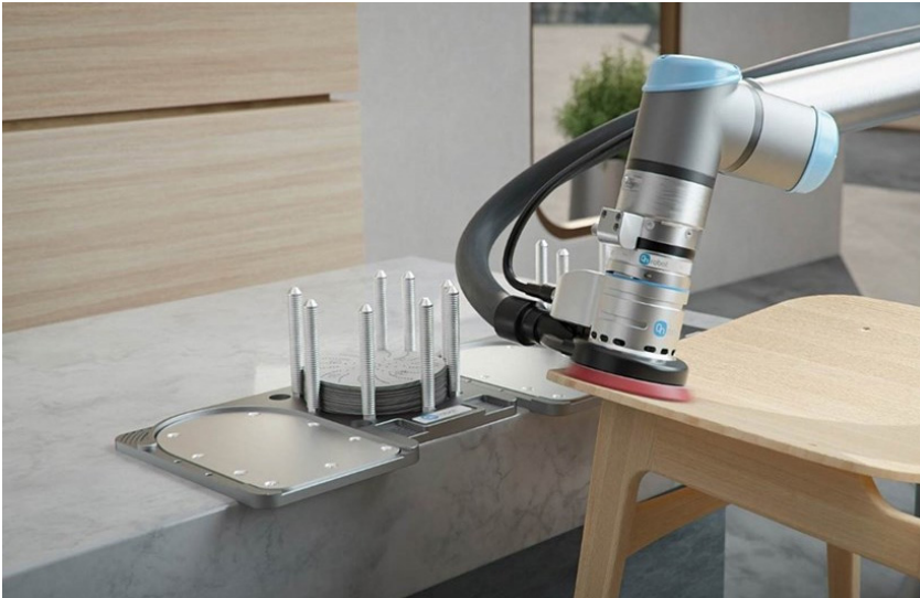
Figura 3.5.4. Exemplo de um Robot colaborativo da Universal Robots a lixar uma peça de mobiliário, 2021. Fonte: https://www.universal-robots.com/blog/robots-sanding-furniture-no-way/
