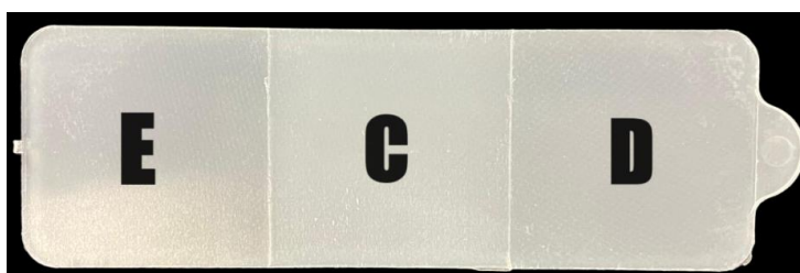
Figura 13 - Esquema das diferentes zonas consideradas na caracterização dos provetes: E – Zona esquerda; C – Zona central; D – Zona direita
