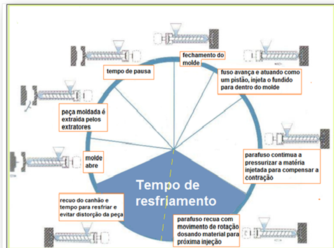
Figura nº 3. Fases do processo de moldação [12]
