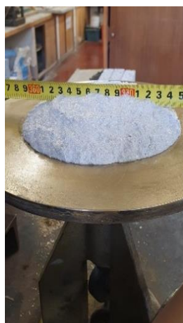
Figura 25 Medição do espalhamento da mistura
