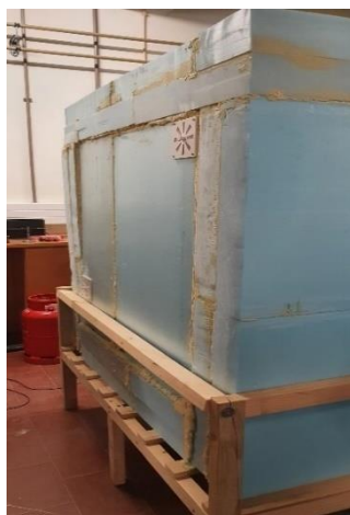
Figura 32 Dispositivos de ventilação na parede posterior da câmara fria.
