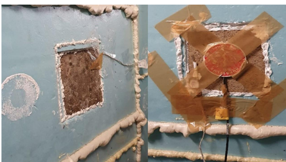
Figura 32 Dispositivos de ventilação na parede posterior da câmara fria.
