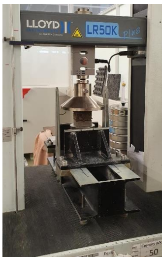
Figura 28 Equipamento utilizado para ensaio à compressão
