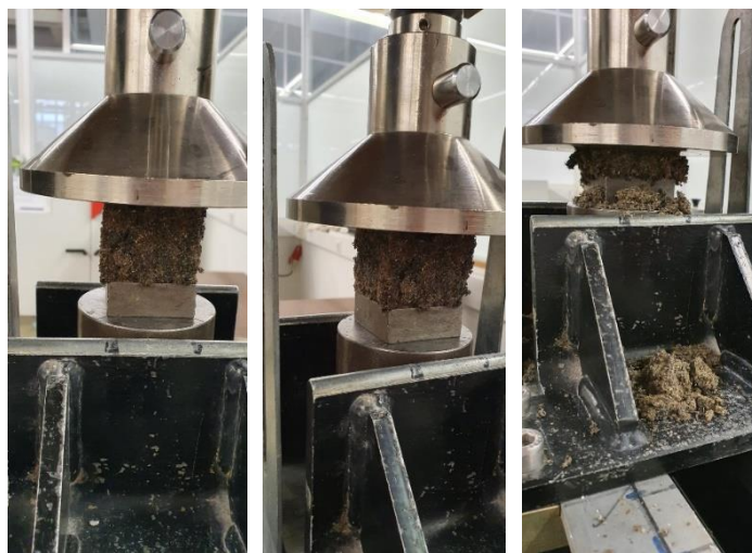
Figura 29 Ensaio de compressão realizado
