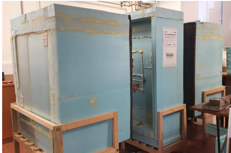
Figura 30 Câmara fria (à esquerda) e câmara quente (à direita). No meio está situada a divisória para colocar o provete a ser ensaiado.
