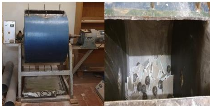
Figura 16 Equipamento de Los Angeles e o gesso com esferas, no interior do equipamento
