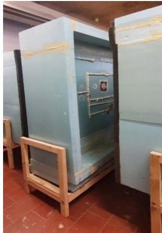
Figura 31 Anel de montagem do equipamento de ensaio de transmissão térmica.
