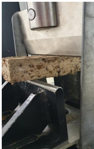
Figura 27 Rotura do provete
