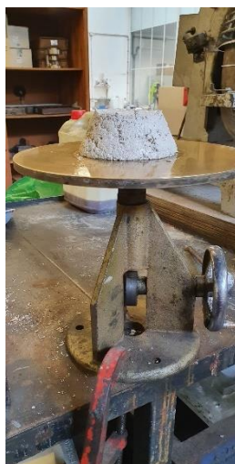
Figura 38 Molde após as 15 batidas da mesa de espalhamento
