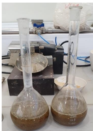
Figura 13 Picnómetro com serrim e água destilada
