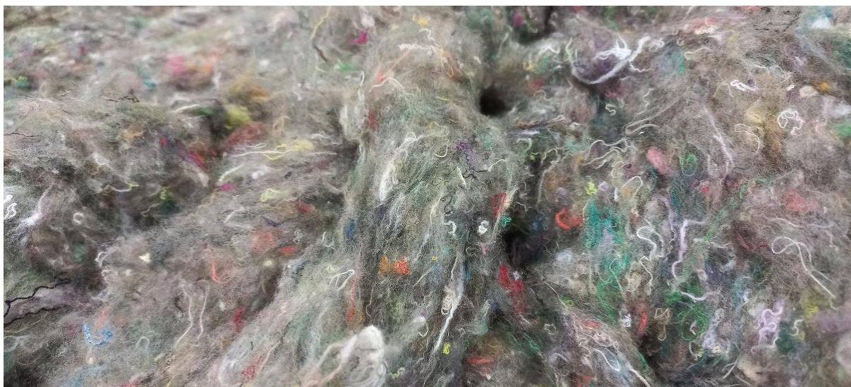
Figura 10: Fibra obtida à saída do módulo de desfibrilação da linha do CITEVE
