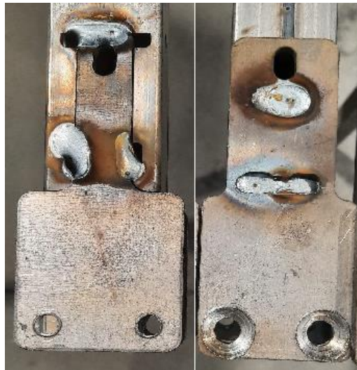
Figura 12: Resultado da soldadura em A e B
