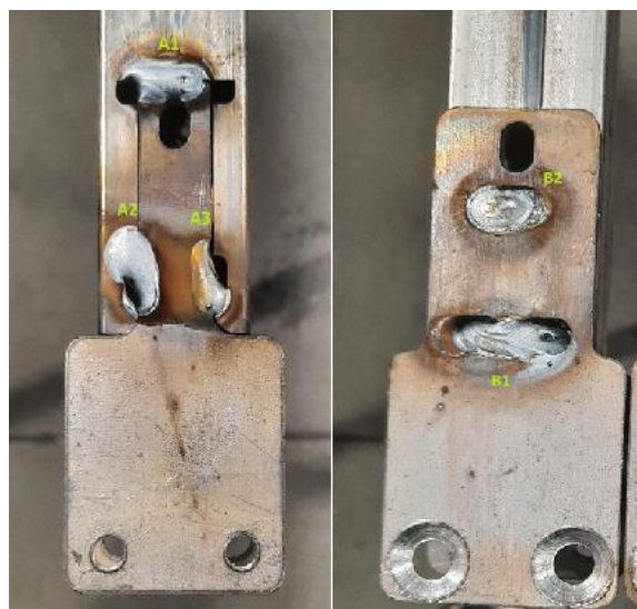
Figura 14: Pontos críticos de A e B
