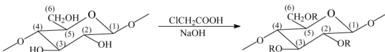
Figura 7 – Representação esquemática da introdução do grupo carboximetilo no anel de glucopirranose, com R=H ou \text{CH}_2\text{COONa}^+ .
