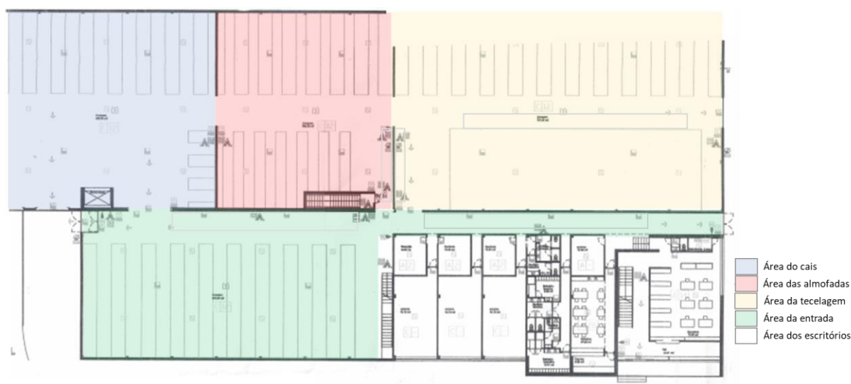
Figura 26 - Layout da unidade física do armazém 900, pavilhão 2.
