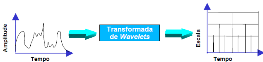
Figura 6-Representação tempo e escala resultante da aplicação da transformada de wavelets (Haar, 1998)
