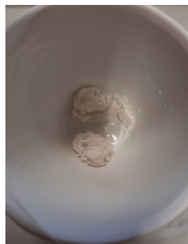
Figura 19 Cinzas obtidas após mineralização da amostra por incineração na Mufla.
