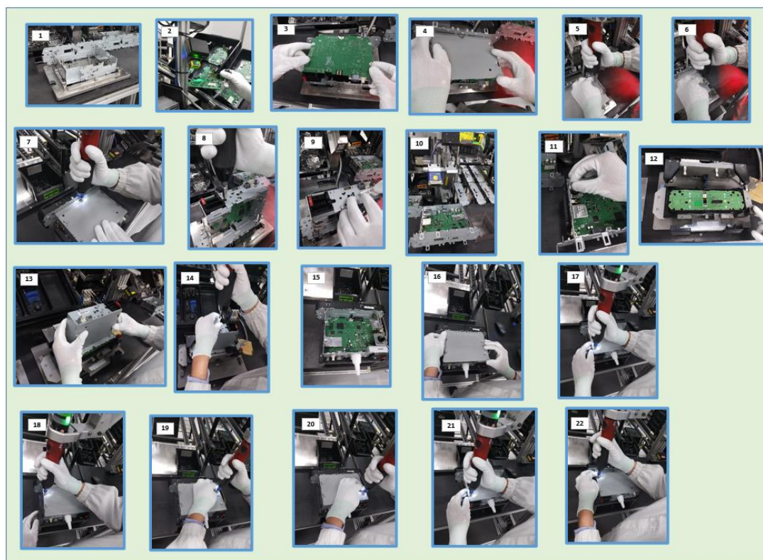
Figura 62 – Simulação das operações de montagem manual dos modelos A e B
