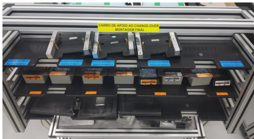
Figura 47 – Carrinho de apoio ao change-over após 5S
