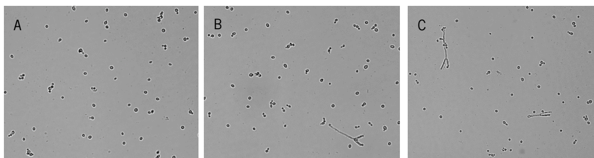
Figura 11. Morfologia de Yarrowia lipolytica CH1/5 durante ensaios de biotransformação de L-Fe em biorreator ao fim de 81 horas de ensaio com uma velocidade de agitação e caudal de ar de 600 rpm e 1 L min -1 (A), 600 rpm e 3 L min -1 de ar (B) e 900 rpm e 3 L min -1 de ar (C).
