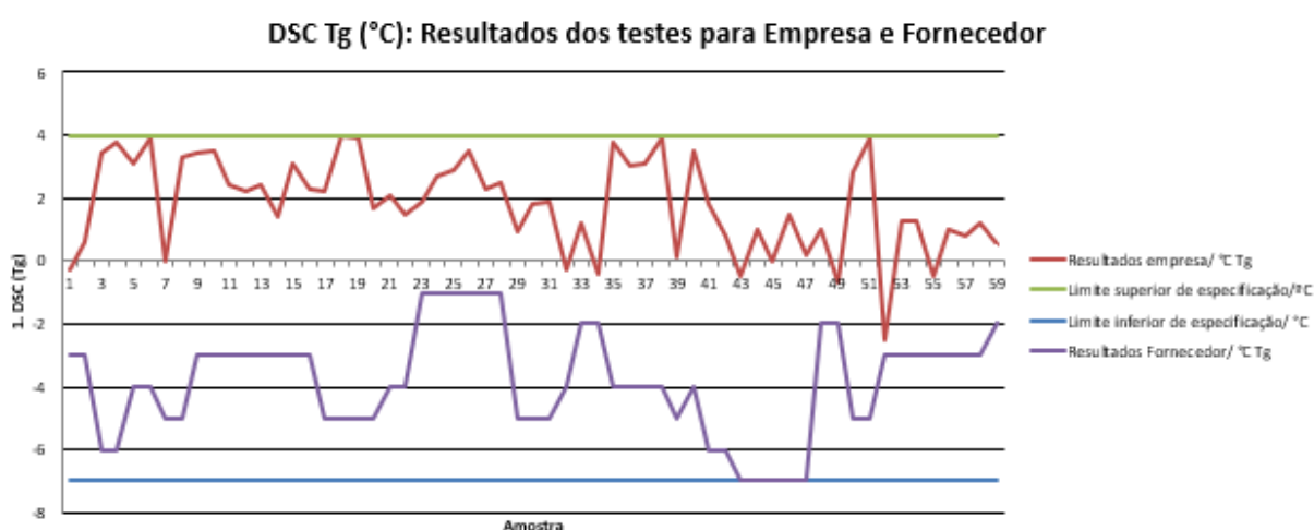
Figura 54 - Resultados dos testes para Empresa e Fornecedor da temperatura de transição vítrea
