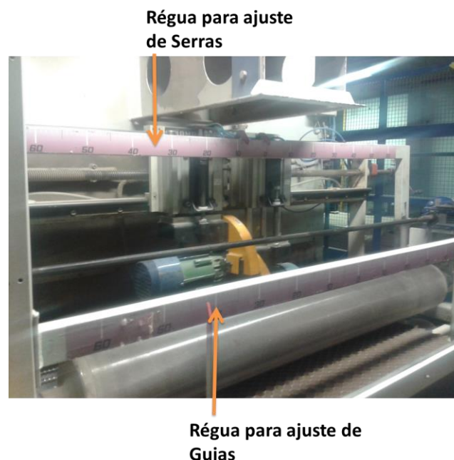
Figura 62 - Réguas fixas na expansora para ajuste de guias e serras de corte.
