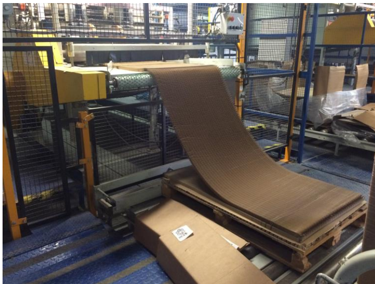
Figura 32 - Entrada de honeycomb na máquina expansora.
