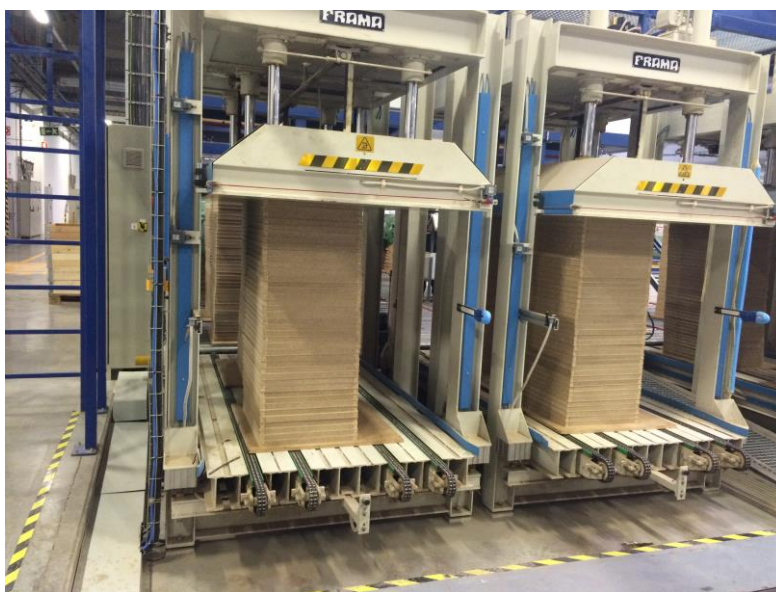
Figura 38 - Prensagem dos painéis BOF.
