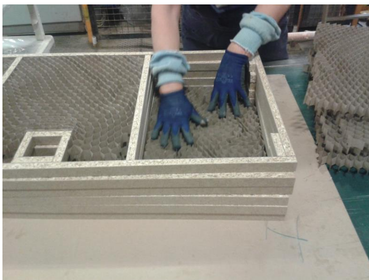
Figura 34 - Introdução de elementos de honeycomb nas estruturas de frames .
