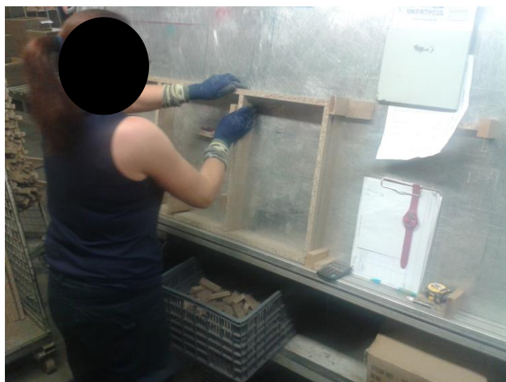
Figura 28 - Montagem manual de frames .
