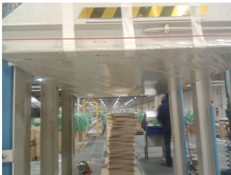
Figura 57 - Proteção dos pratos de prensagem com plástico.
