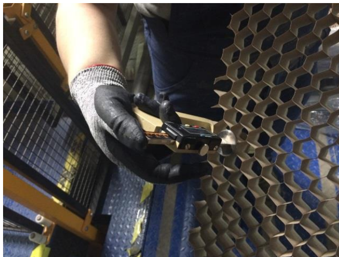
Figura 40 - Medição da espessura do honeycomb .
