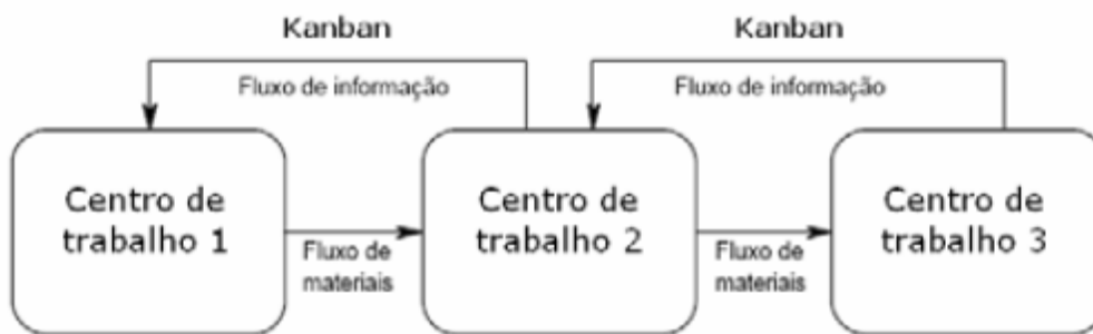
Figura 14 - Funcionamento do sistema Kanban (Pinto, 2009).
