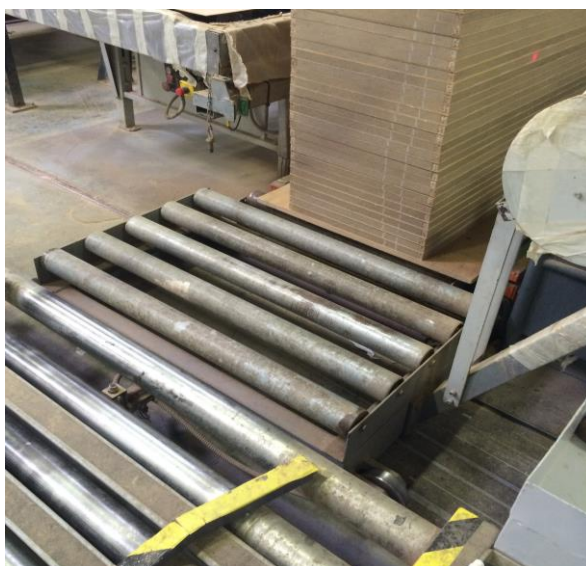
Figura 47 - Descarga de paleta de elementos BOF com carro de rolos manual.
