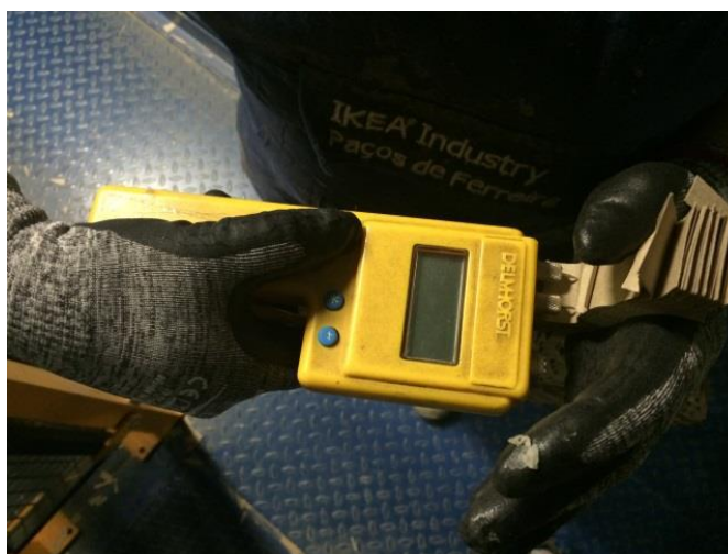
Figura 41 - Medição de humidade do honeycomb .
