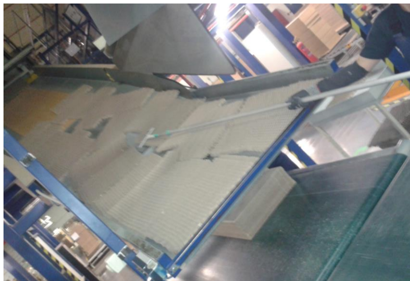
Figura 61 - Utilização de garfo extensível para deslocação de HC para a saída do buffer .
