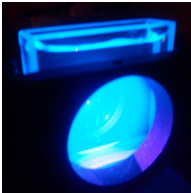
Figura 33- Exemplo de uma solução fluorescente colocada no porta-amostras.
