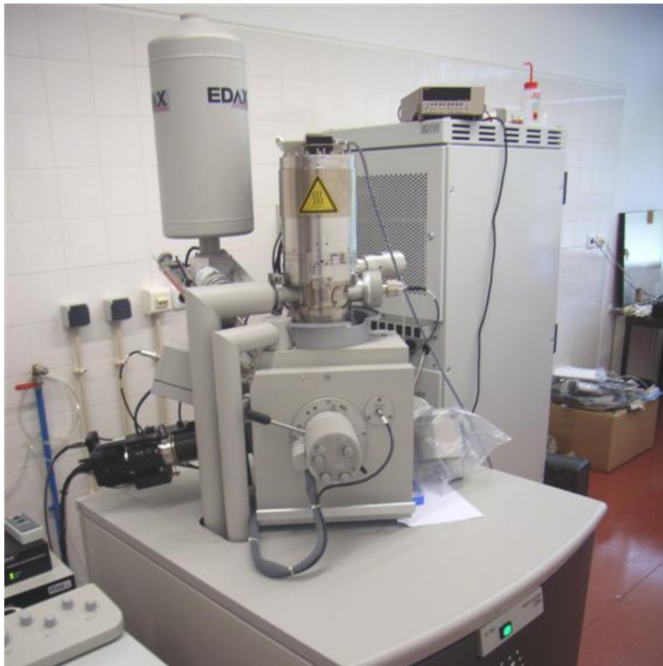
Figura 35- Microscópio eletrónico utilizado na caracterização das microcápsulas. [SEMAT]
