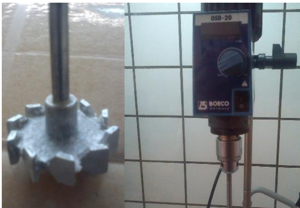
Figura 23- Hélice e agitador mecânico utilizados para a formação das emulsões.
