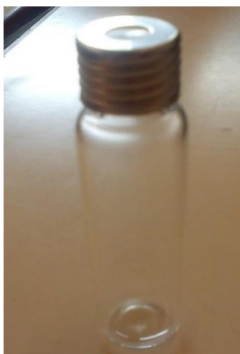
Figura 37-Vial onde são colocadas as amostras a analisar no GC-MS.
