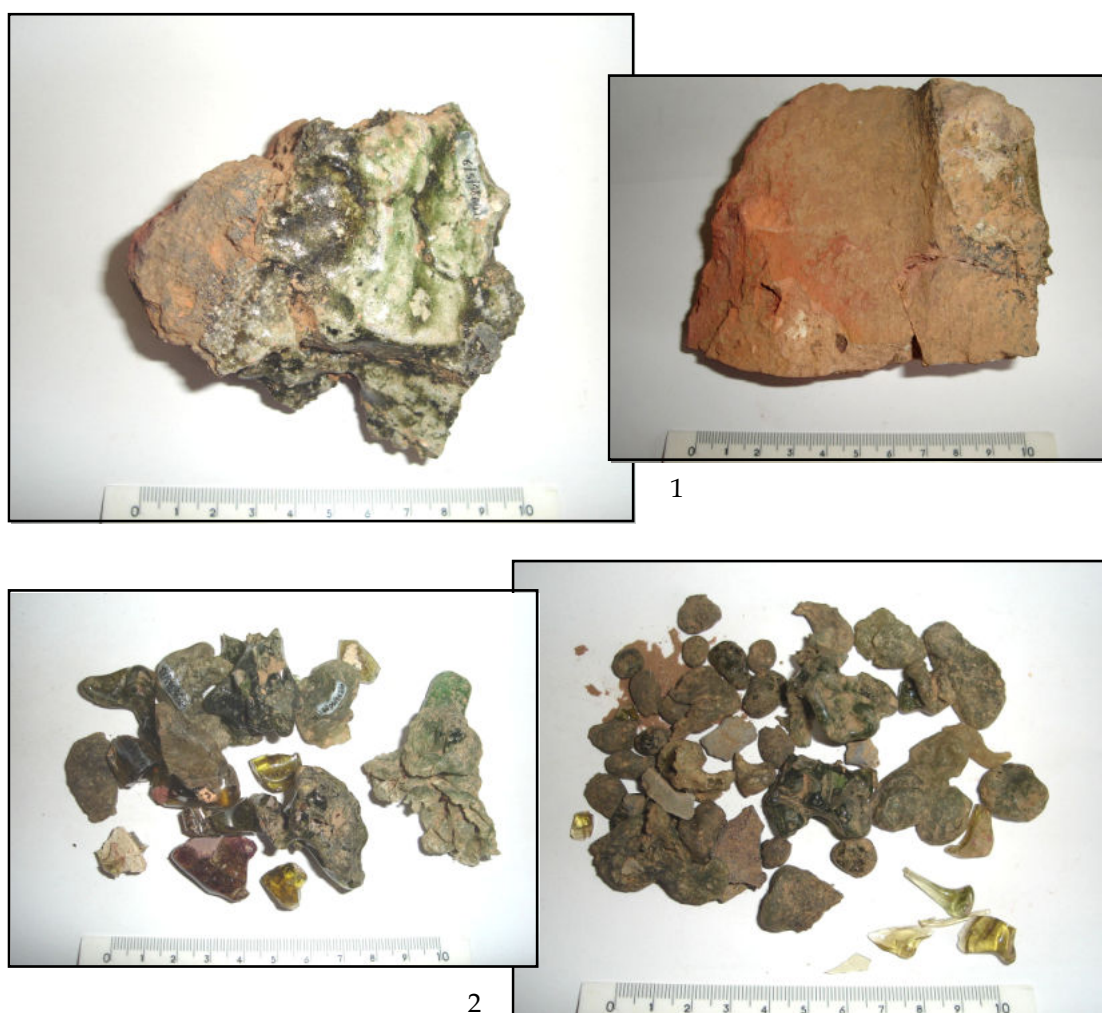
Fig. 5.2.2a: Restos de forno e indícios de produção da oficina da R. Loureiro, Tui: 1 – fragmentos de barro cozido e tégula com escorrências de vidro verde amarelado (TuiLOU11 e 12); 2 – escórias e restos de fabrico em vidro verde azulado, verde amarelado e amarelo violáceo (TuiLOU10).
