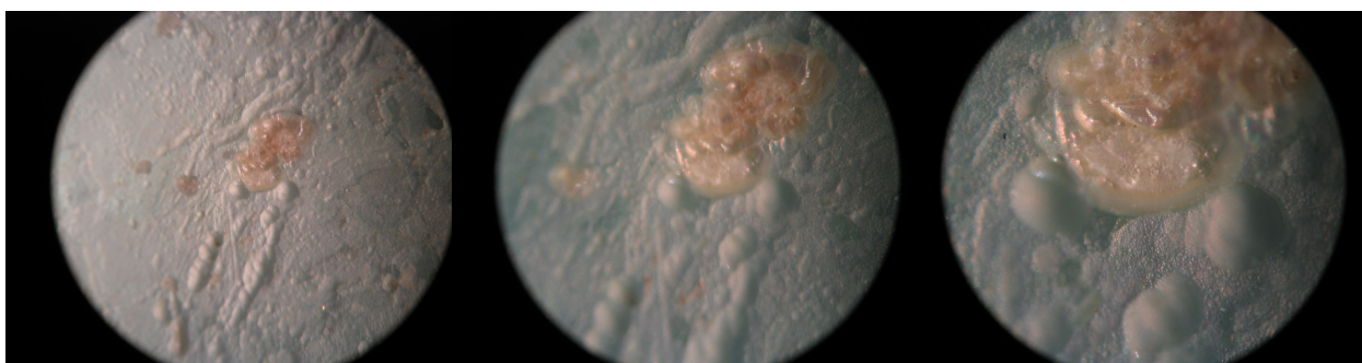
Fig. 2.22l: corrosão com formação de película esbranquiçada com mancha acastanhada, também designada corrosão leitosa
