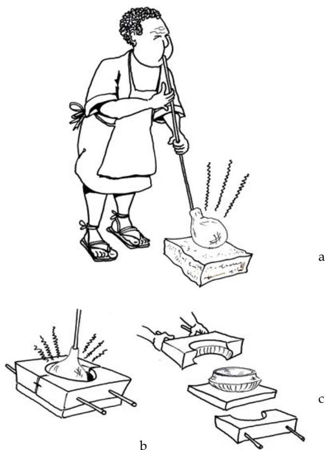
Fig. 4.3.24a: Argenti modo caelare . Taça canelada soprada em molde: a) dar forma ao balão de vidro com a ajuda da marma; b) soprar o balão de vidro dentro do molde; c) desenformar a taça e separa-la, a frio, da “boca de cana”. Desenho de Luís Costa para Vita Vitri (Cruz 2009).
